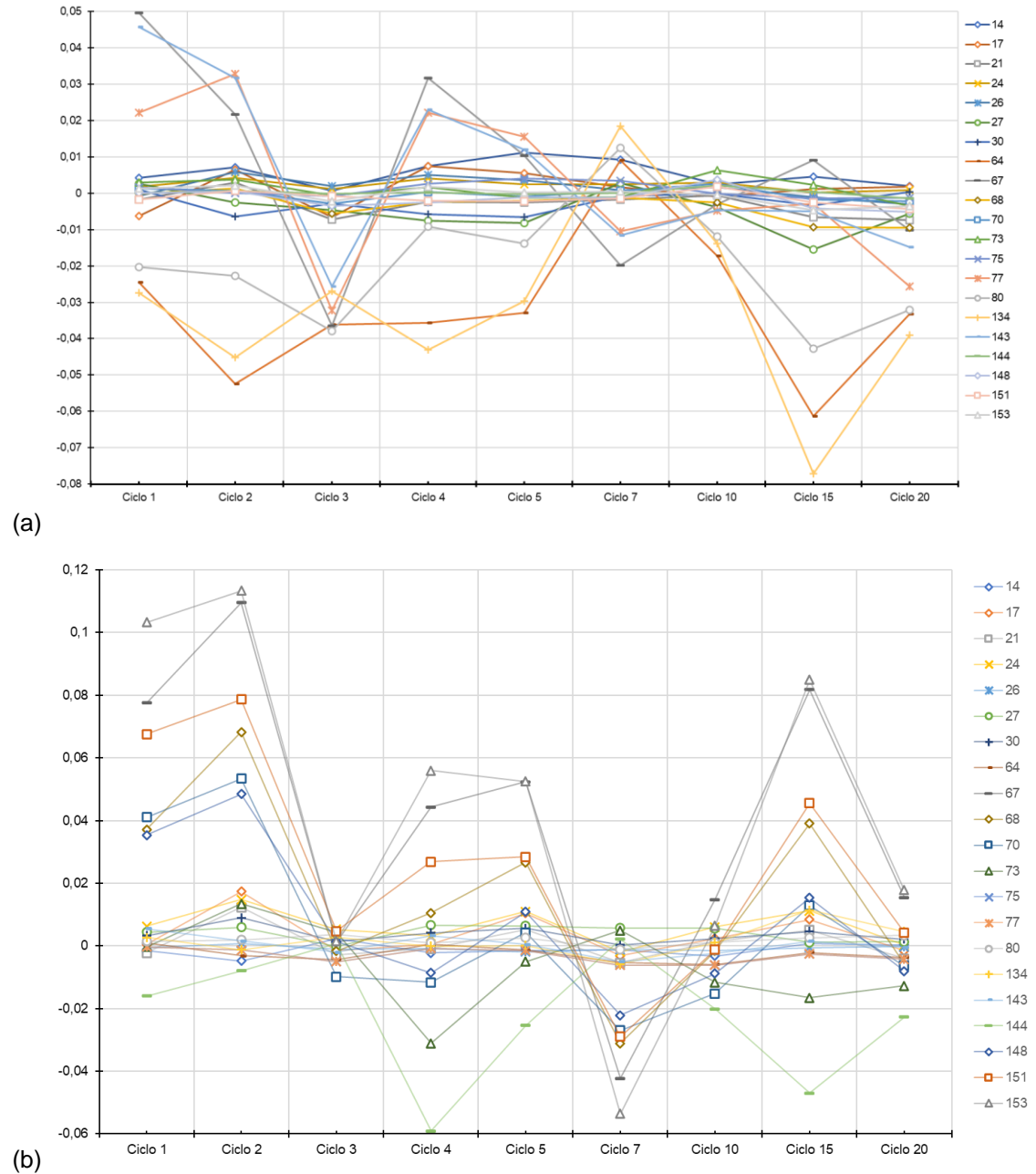
Figura 40 – Variação da deformação da ferramenta nas superfícies das curvas positiva e negativa e boleados, em diversos pontos conforme ANEXO 3. (a) - Direção eixo XX; (b) - Direção eixo YY.
