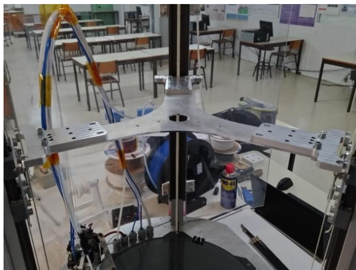
Figura 31 – Modelo utilizado para avaliar a planeza entre as rótulas e as distâncias entre os centros das mesmas.
