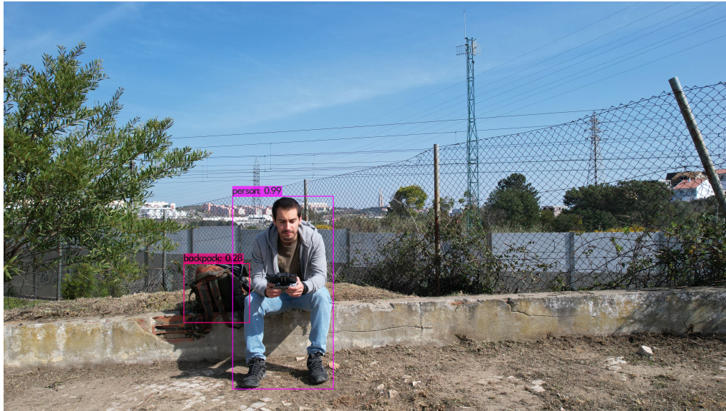
FIGURA 3.2: Primeira deteção com o YOLOv4-tiny no computador, detetando uma mochila e uma pessoa, recolhida pelo drone pessoal DJI Mavic Air 2S.
