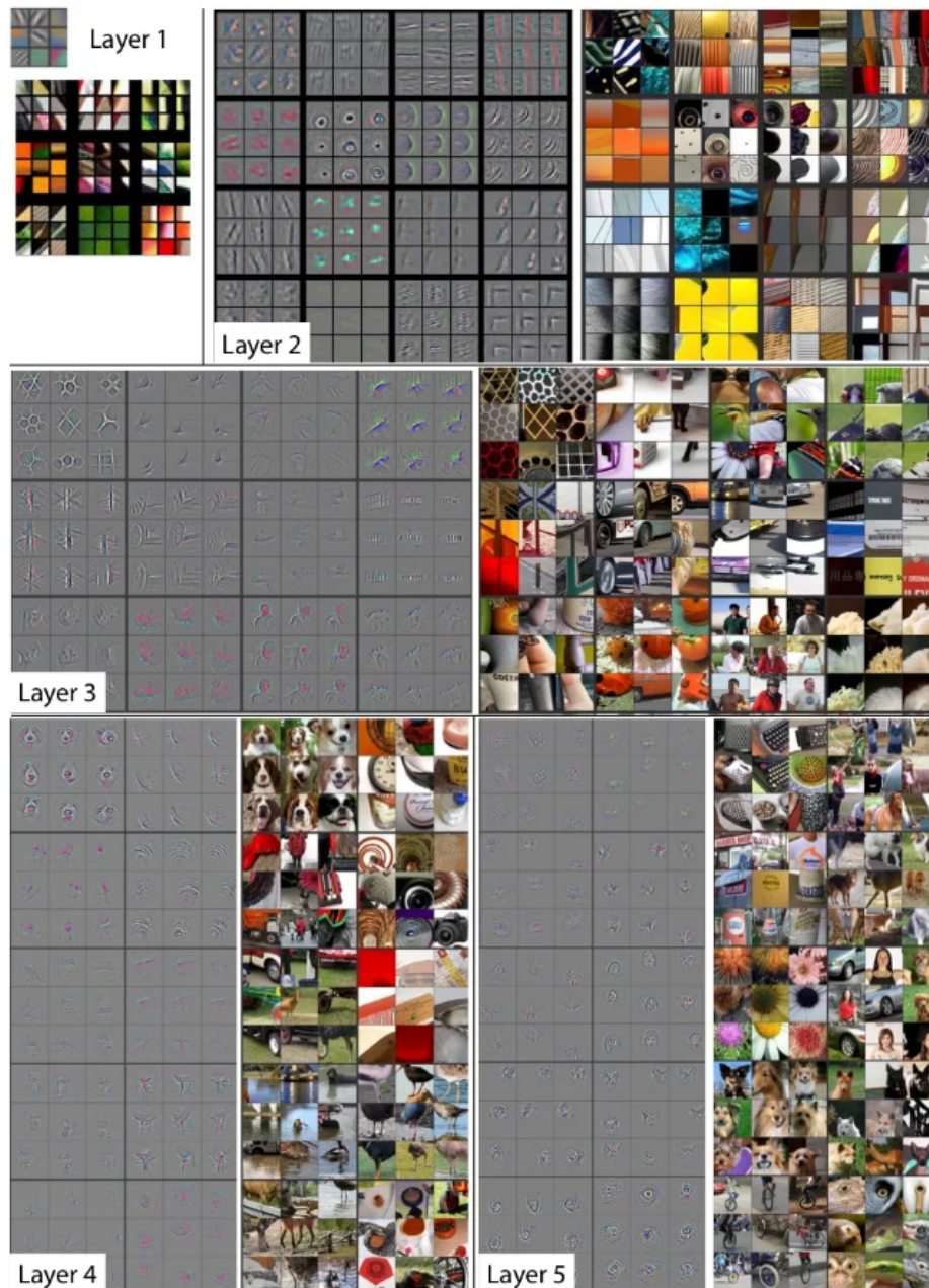
FIGURA 2.9: Diferentes filtros em diferentes camadas numa CNN, retirado de (Dickson 2019).
