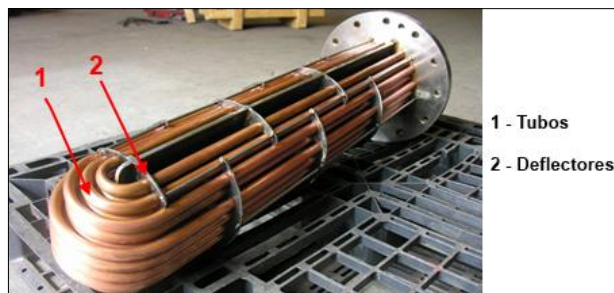
Figura 55 – Feixes tubulares de um permutador multitubular [16].
