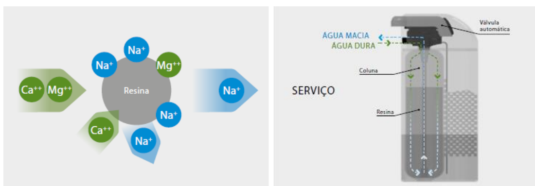
Figura 32 – Princípio da descalcificação [13].
