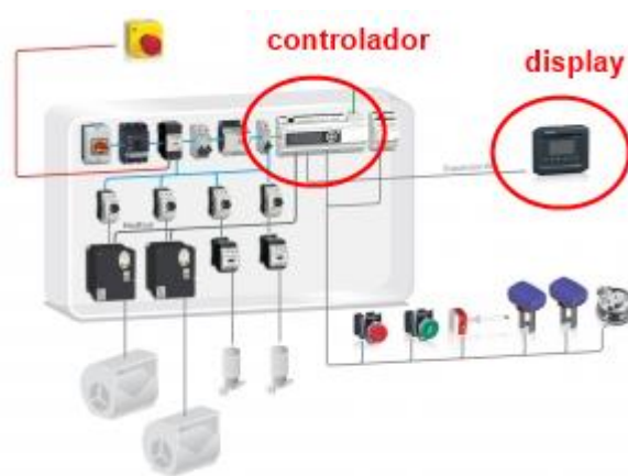
Figura 91 – Esquema de funcionamento de um quadro de comando de uma UTA [21].
