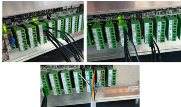
Figura 4.25: Ligações do controlador do robô.
