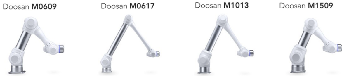
Figura 1.4: Robôs da série M da Doosan Robotics 4 .
