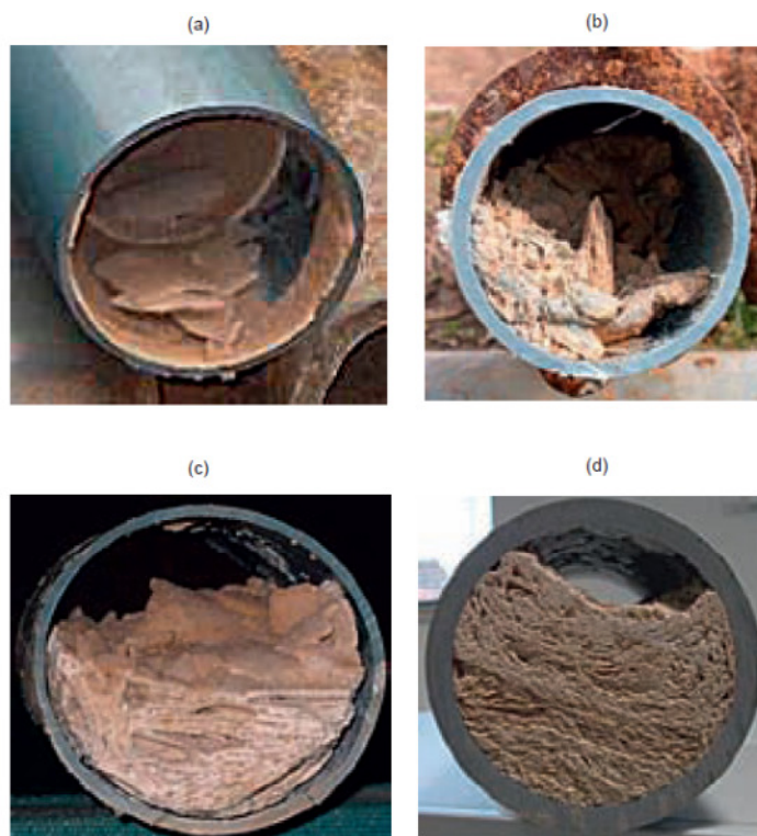
Ilustração 9 - Exemplos de incrustação em condutas de materiais plásticos (o caso do PVC): a) formação e desagregação de camadas de \text{CaCO}_3 ; b) exemplos de formas de deposição não coesiva de \text{CaCO}_3 ; c) e d) exemplos de formas de deposição coesiva de \text{CaCO}_3
