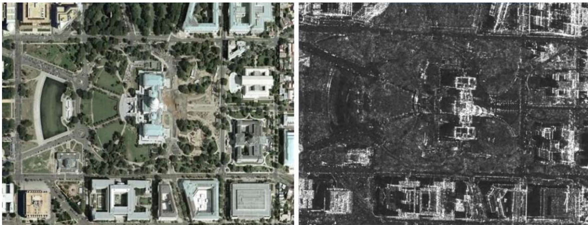
Figura 2 – Diferença entre as imagens de um Sensor Óptico (esquerda) e um Sensor Radar (direita) Fonte: disponível em https://www.grss-ieee.org/wp-content/uploads/2014/07/PT_TUTORIAL_COMPLETO.pdf
