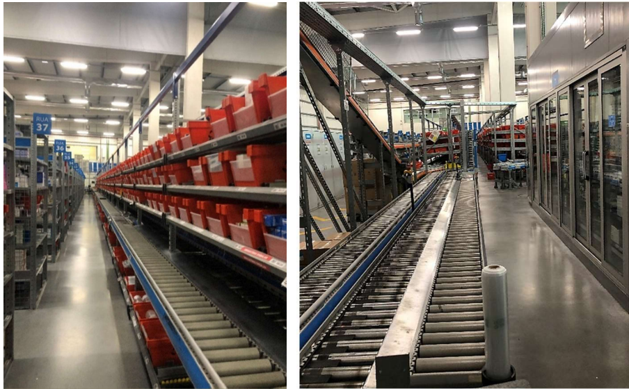
Figura 16 – Sistema de picking manual (esquerda – picking de produtos à temperatura ambiente; direita – picking de produtos de frio)
