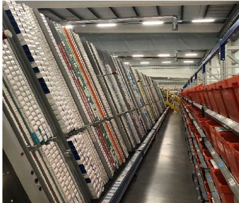
Figura 14 – Canais e apoio do sistema de picking automático ( A-Frame ) da plural+udifar
