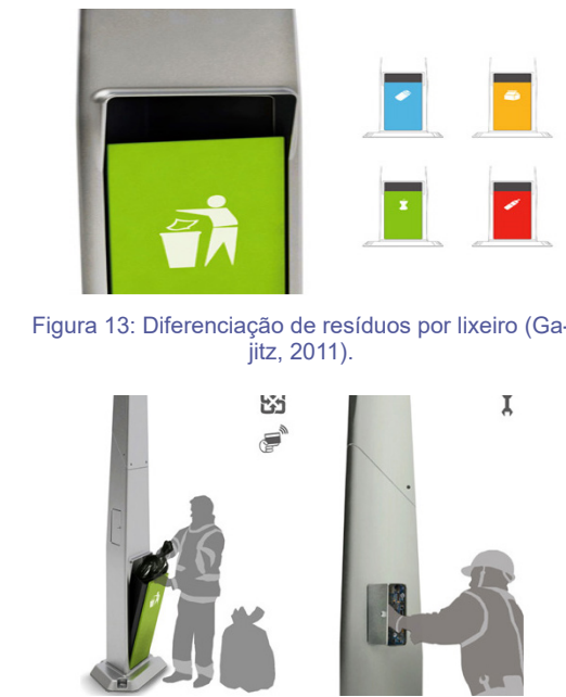
Figura 14: Esquema de liberação de acesso aos compartimentos (Gajitz, 2011).
