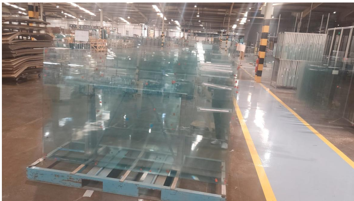
Figura 20: Cavalete de vidro
