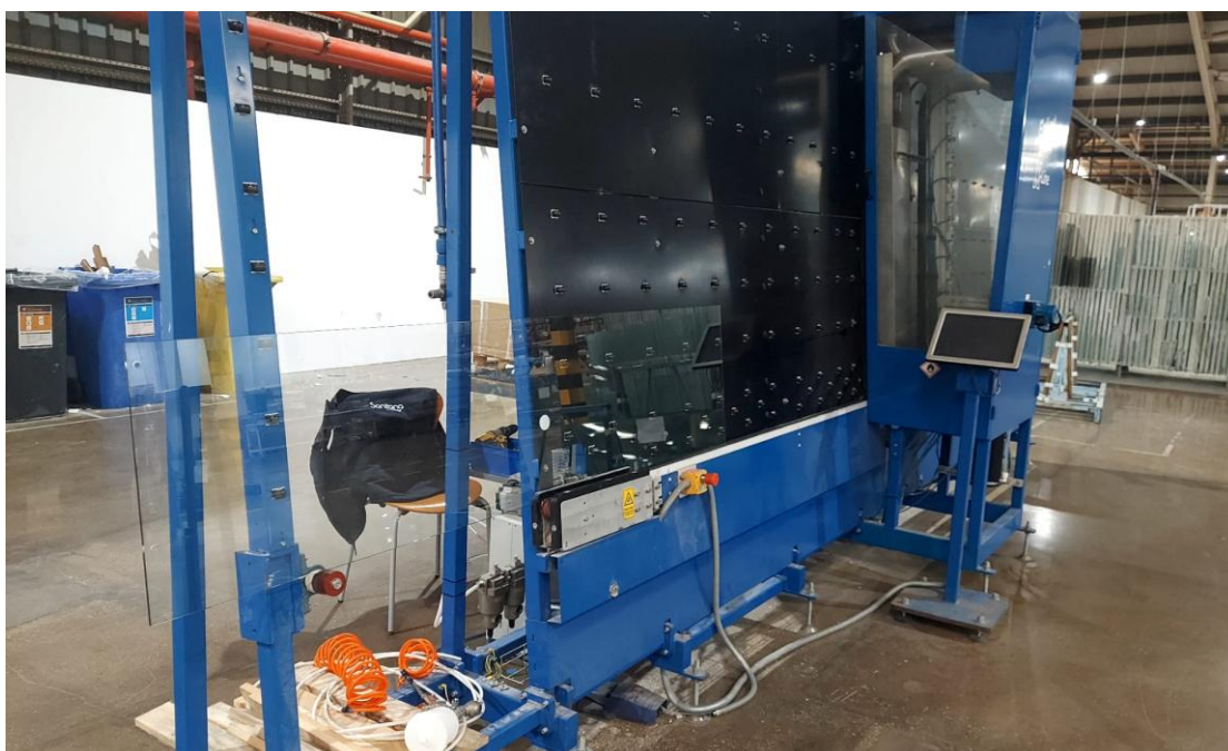
Figura 22: Máquina para aplicação de tratamento anticalcário
