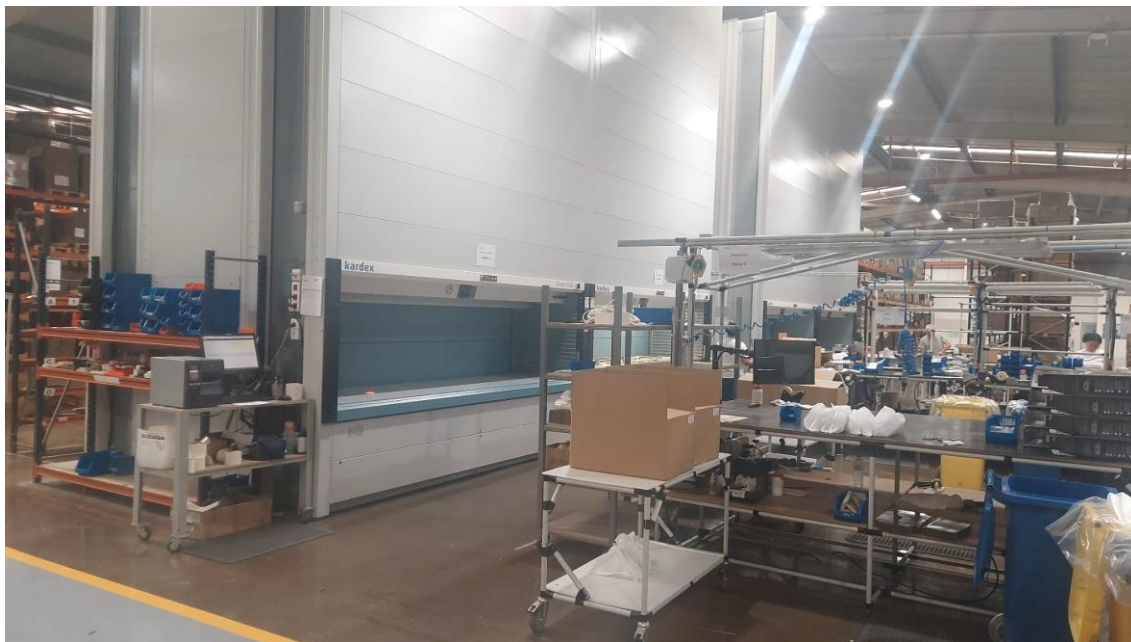
Figura 15: Armazém automático vertical
