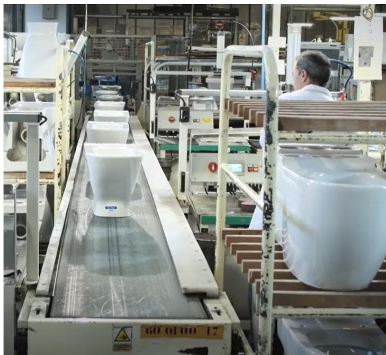
Figura 9: Linha de inspeção final
