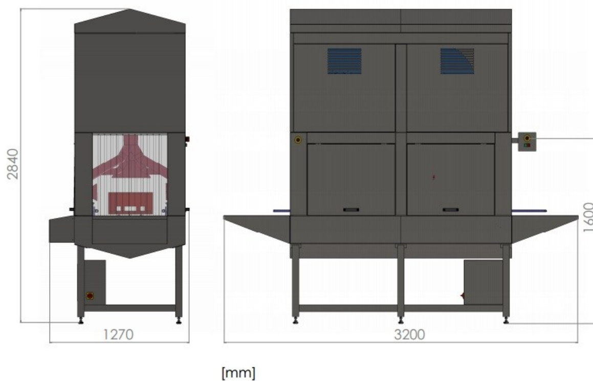
Figura 9-Cotas gerais (em valores aproximados)
