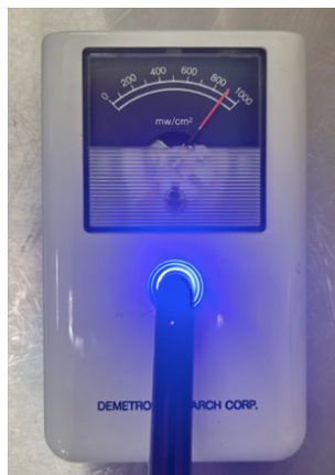
Figura 13. Utilização do radiômetro para as medidas da intensidade da luz do fotopolimerizador. Realizado no laboratório do Instituto Universitário Egas Moniz.
