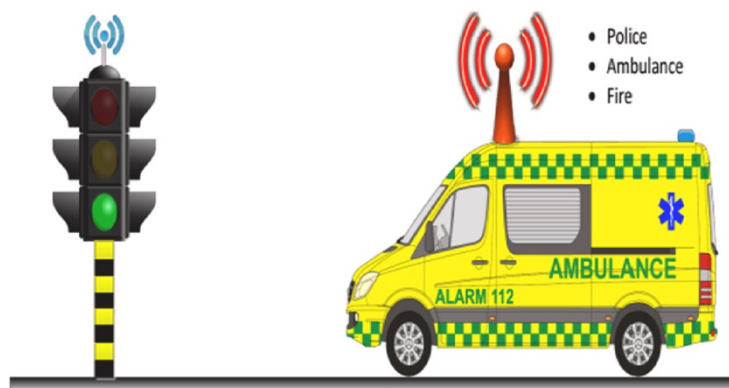
Figura 5 – Comunicação entre o veículo de emergência e semáforo
