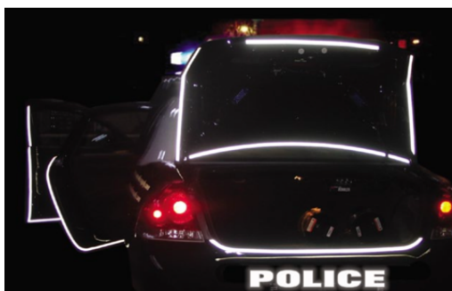
Figura 11 – Marcações de contorno no interior das portas
