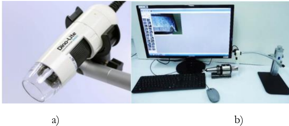
Figura 3.14 – Equipamento de avaliação visual do desgaste: a) microscópio ótico; b) software de aquisição de imagens (Marouvo, 2022).
