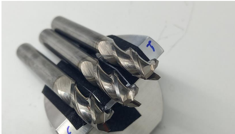
Figura 4.18 – Orientação das ferramentas para a incidência do feixe de eletrões na análise no MEV.
