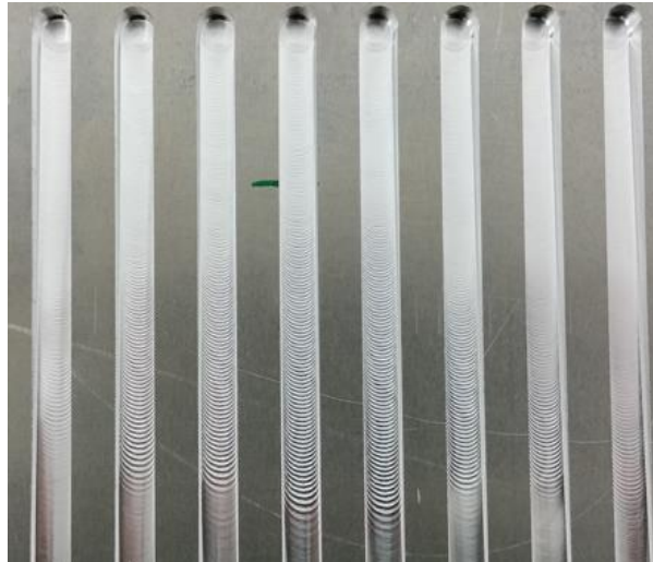
Figura 4.38 – Marcas da ferramenta na base das rampas de 3° de inclinação, sendo mais acentuada nas rampas produzidas na zona central.
