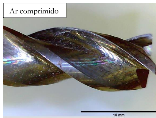
Figura 4.16 – Desgaste no gume de corte mais afetado (ar comprimido). Ampliação de 20X.
