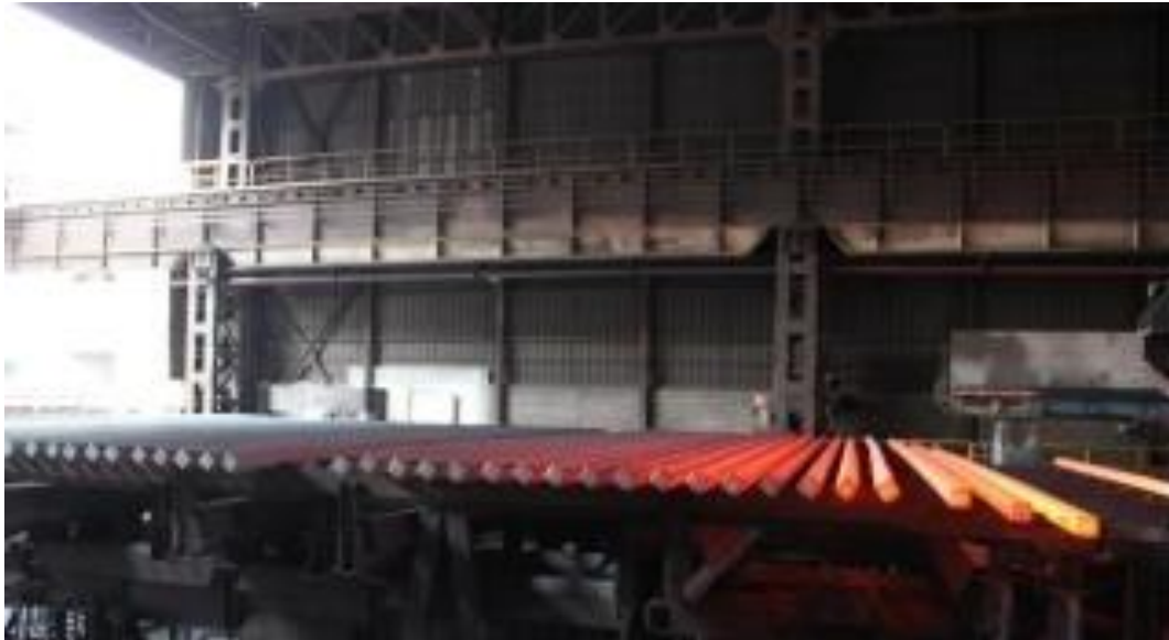
Figura 6 - Zona de arrefecimento de biletas
