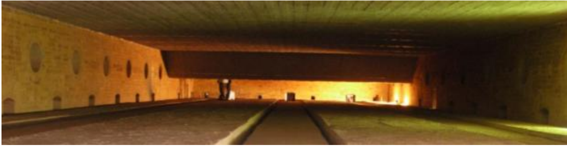
Figura 22 - Interior de um forno do tipo Walking Hearth
