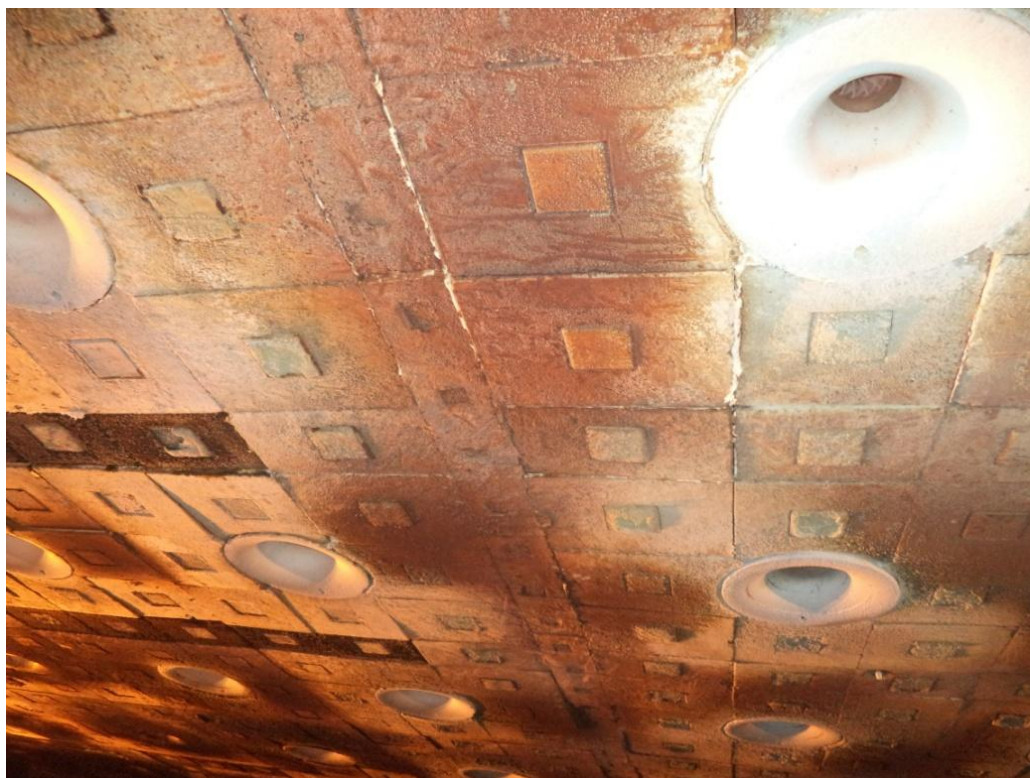
Figura 62 - Distribuição dos queimadores de teto das zonas 1 e 2
