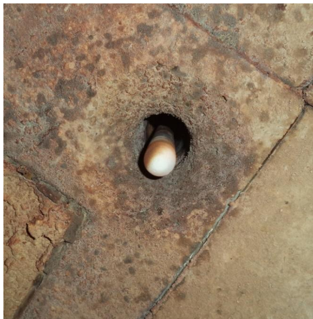
Figura 66 – Encapsulamento do termopar no interior do forno
