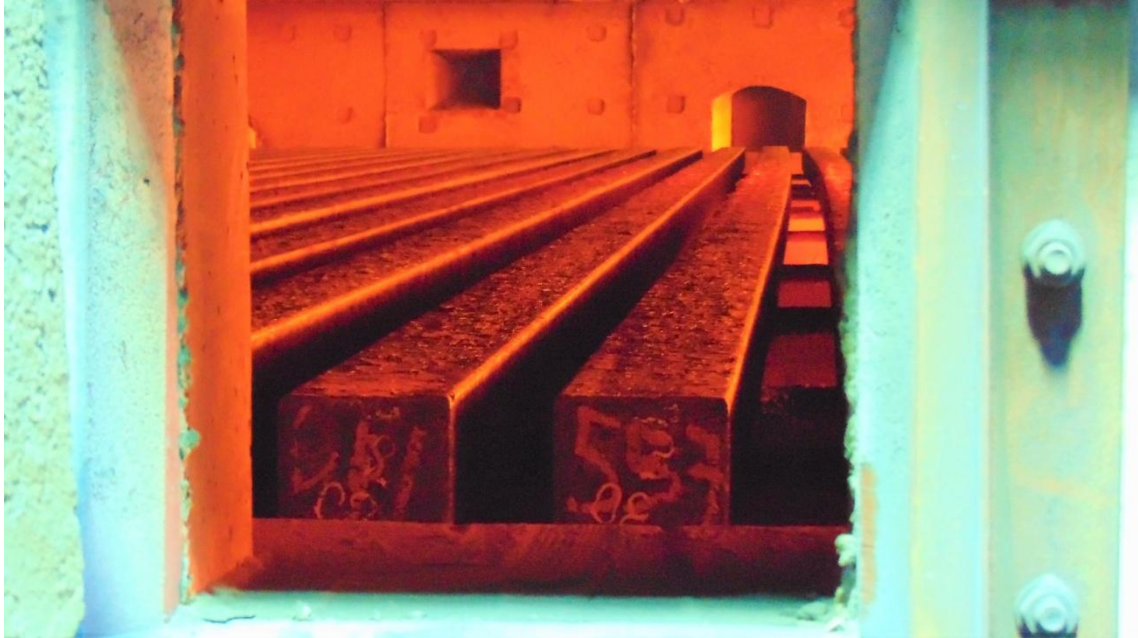
Figura 19 - Espaçamento entre biletas
