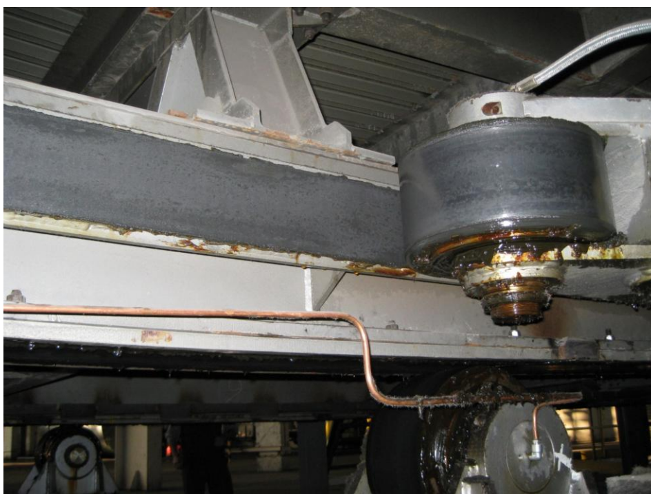
Figura 29 - Sistema de centragem da soleira
