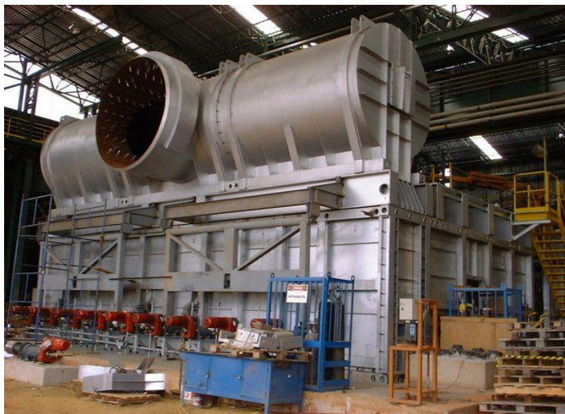
Figura 43 - Saída de fumos do tipo superior (up-take)
