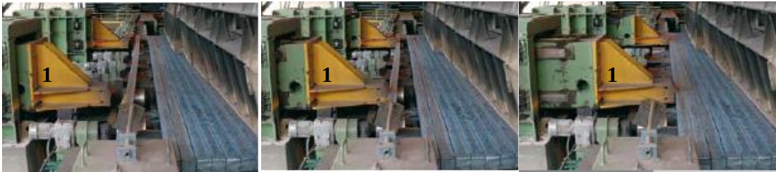
Figura 16 – Sequência do movimento de enformamento
