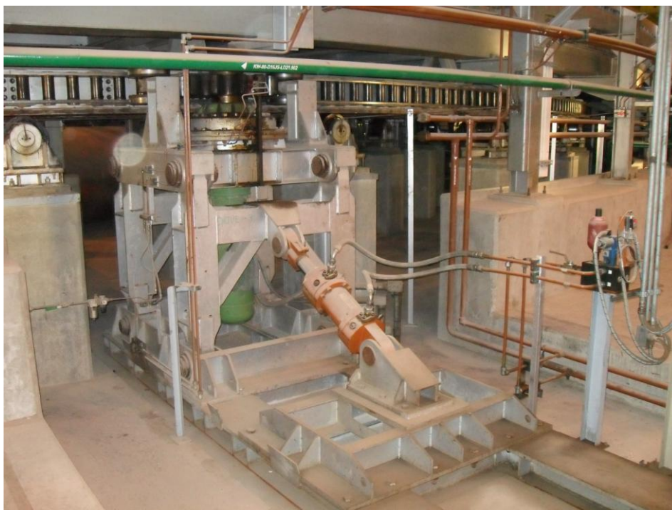
Figura 28 - Sistema de acionamento da soleira do forno rotativo
