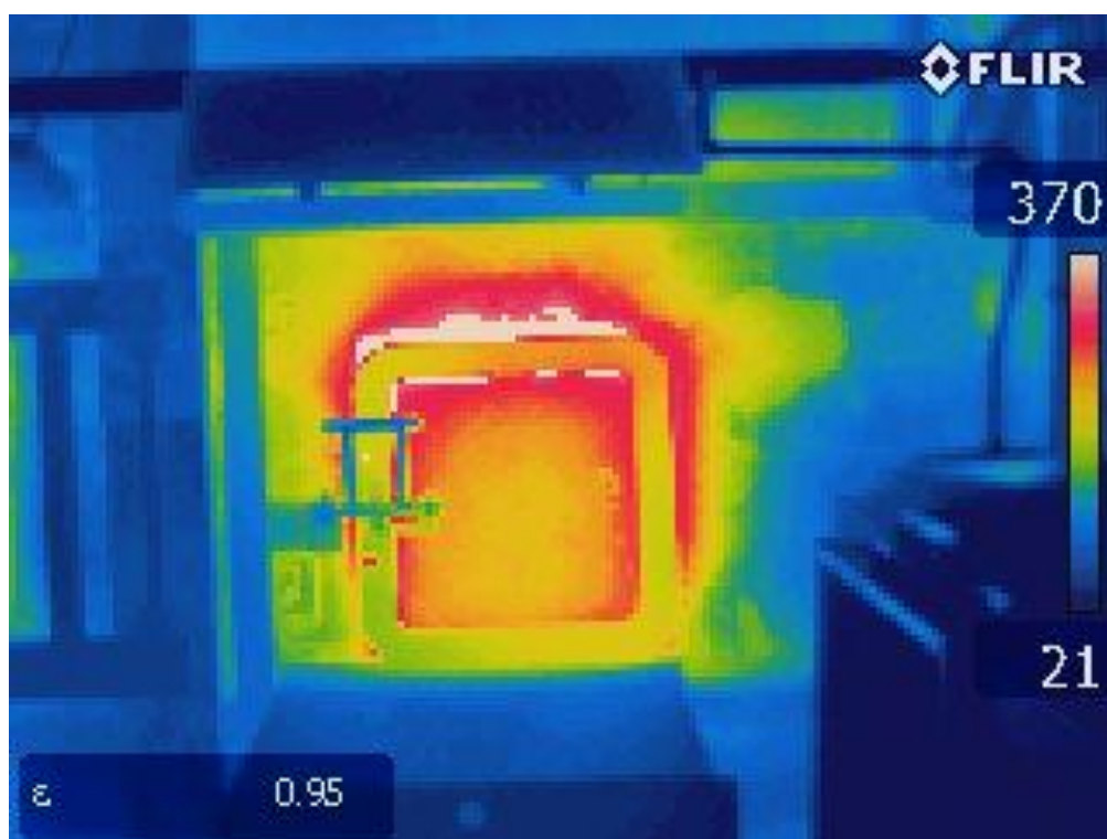
Figura 95 - Análise termográfica a uma porta de inspeção lateral
