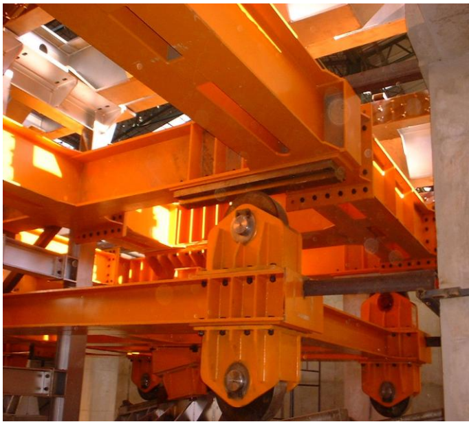
Figura 20 - Aspeto construtivo da soleira móvel
