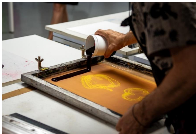
Figura 42. Aplicação da tinta natural a uma matriz serigráfica para posterior (junho de 2024).
