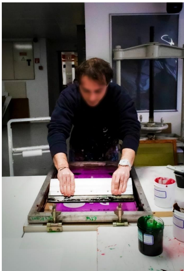
Figura 49. Aplicação de tinta natural a uma matriz serigráfica para a impressão de um cartaz (março de 2025), Print Lab do IADE.
