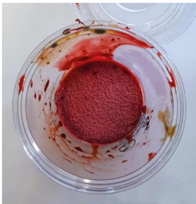
Figura 32. Degradação da tinta, após uma semana sem refrigeração (abril de 2024).
