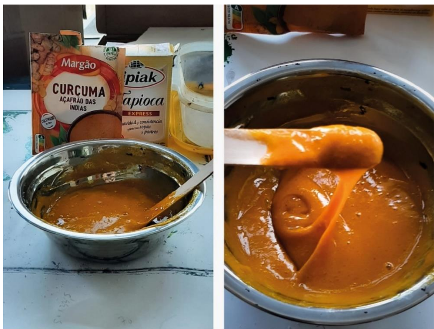
Figura 33. Amostra de tinta obtida a partir de curcuma em pó em que o espessante foi tapioca e pormenor da espessura da tinta (abril de 2024).
