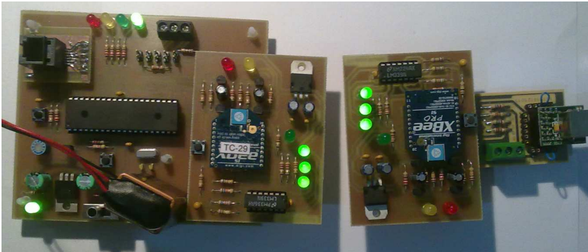
Figura 70 - Comunicação sem fios entre os dois dispositivos
