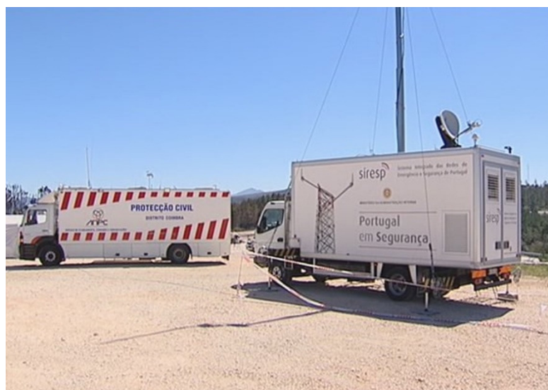
Figura 2: Estação móvel de transmissão do SIRESP (fonte: SIRESP, 2021)
