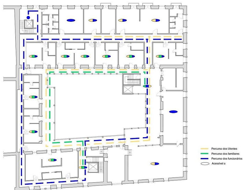
Planta de circulação do piso 1
