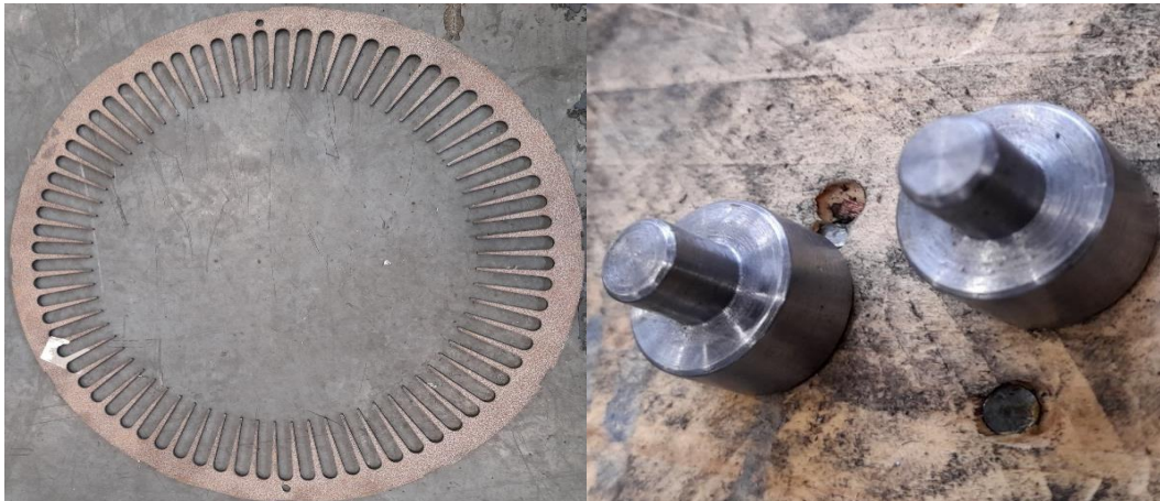
Figura 38 - Fotografia de uma chapa extrema com furos centradores e de dois casquilhos.
