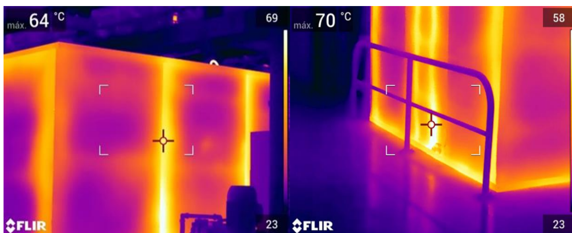
Figura 30 - Análise termográfica na zona traseira da estufa.
