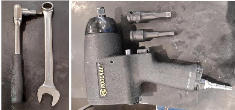
Figura 35 - Fotografia da chave de bocas e roquete (esquerda) e máquina de impacto com acessórios (direita).
