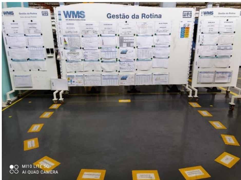
Figura 14 - Zona demarcada para gestão de rotina da Montagem.
