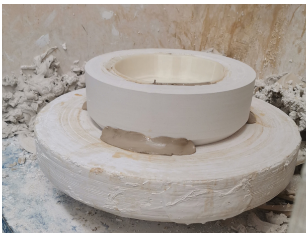
Img. 72 - Colocação do novo barro e limpeza do excesso anterior.
