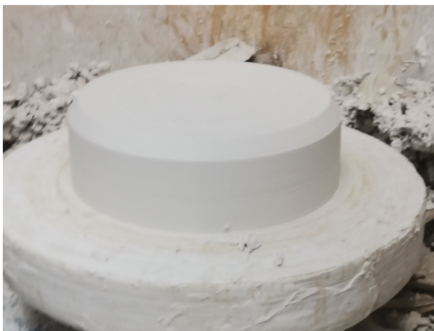
Img. 71 - Acabamento do molde.
