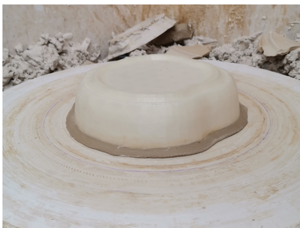
Img. 68 - Colocação do gesso nas extremidades das peças.
