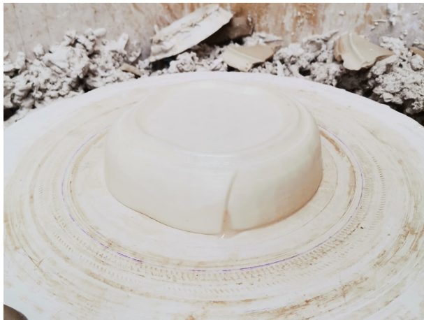
Img. 67 - Peça colocada no torno.
