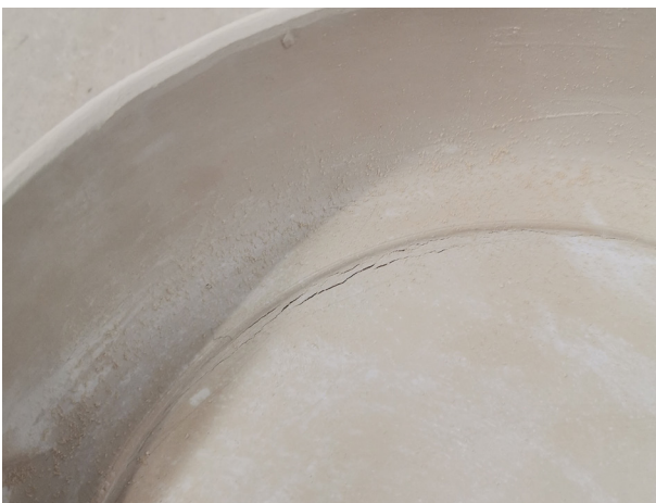
Img. 79 - Erro no interior da peça - peça crua.
