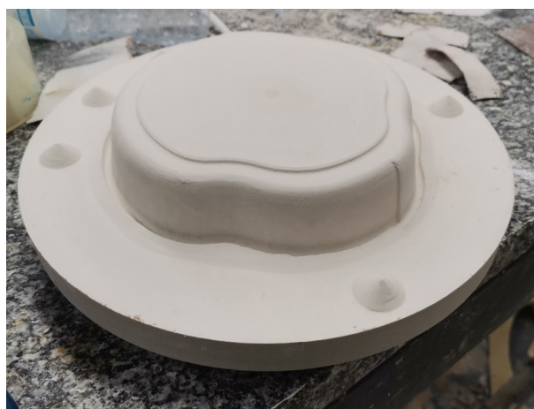
Img. 74 - Uma das metades do molde finalizada.
