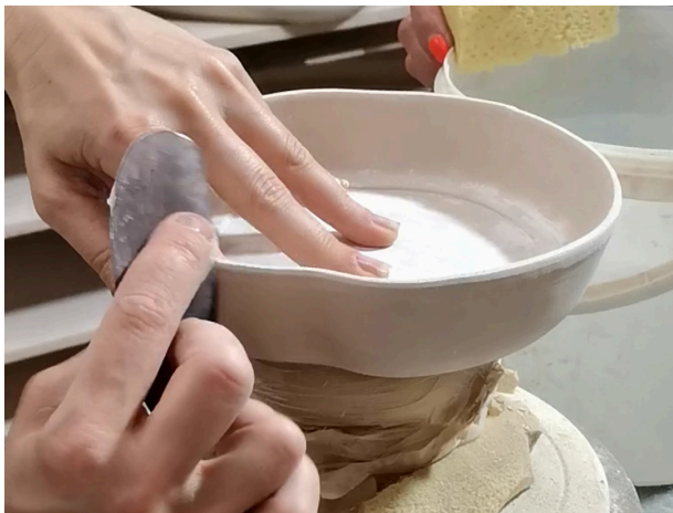
Img. 82 - Aperfeiçoamento manual dos erros das peças.
