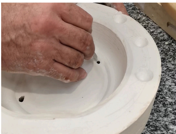
Img. 83 - Aperfeiçoamento do molde.
