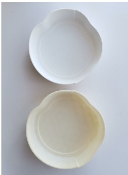
Img. 45 - Comparação entre o tamanho normal e o tamanho com retração.
