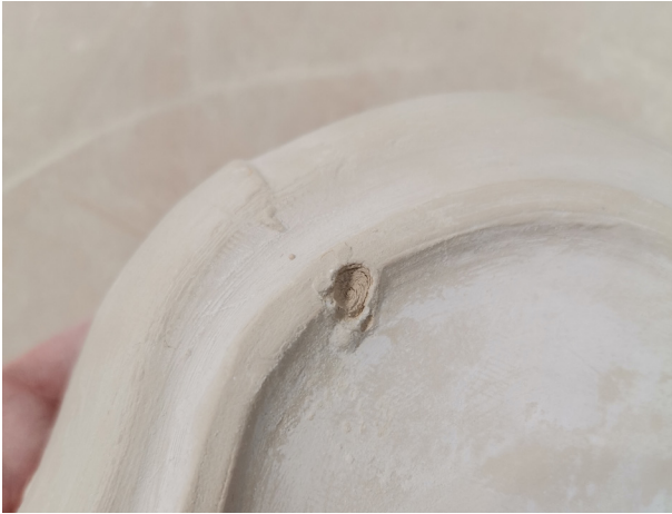
Img. 77 - Bolha rebentada - peça crua.
