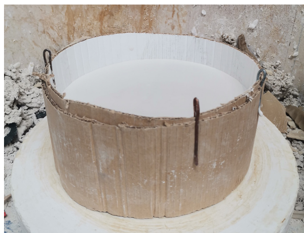
Img. 70 - Vazamento do gesso de enchimento líquido.
