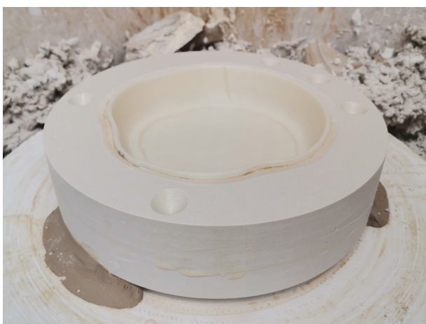
Img. 73 - Colocação do desmoldante.
