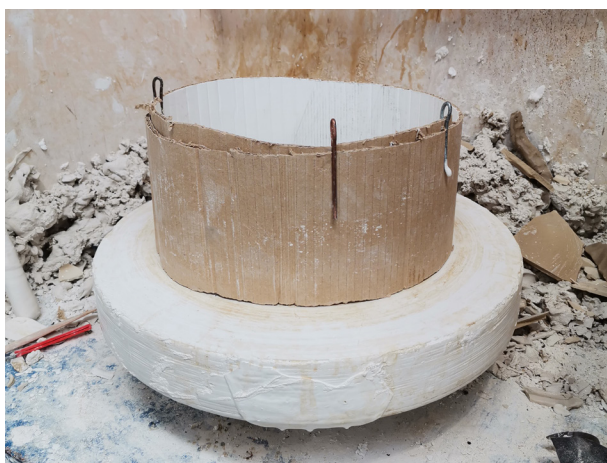
Img. 69 - Colocação do cartão canelado.
