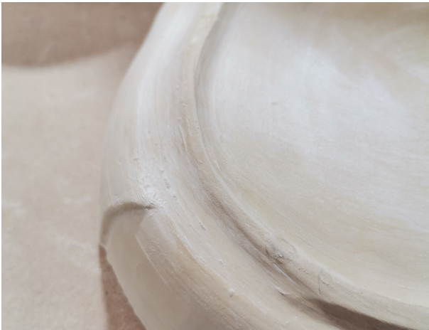
Img. 78 - Erro na geometria do frete - peça crua.
