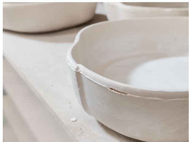
Img. 81 - Erro na borda exterior da peça.
