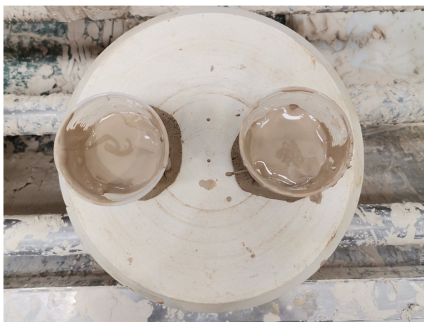
Img. 76 - Colocação da barbotina no molde.
