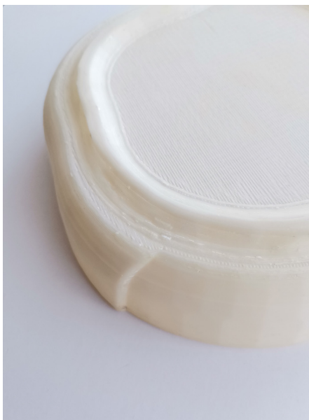
Img. 42 - Pormenores do desnível exterior e frete do quarto modelo da taça.
