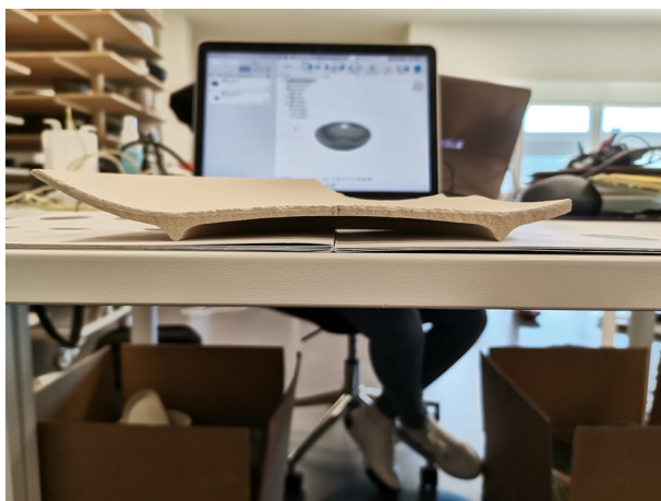
Img. 127 - Peça em cru partida ao meio para levantamento de medidas.
