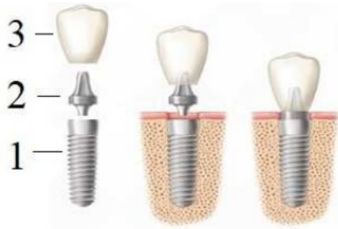
Figura 6.: Prótese dentária: 1- corpo do implante, 2- pilar, 3- coroa (adaptado Sotova et al., 2023).
