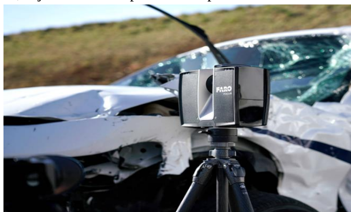
Figura n.º 2 – Laser Scanner 3D Faro Focus
