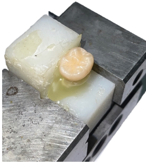
Figura 5 - Posicionamento da amostra no bloco de acrílico em relação à máquina
