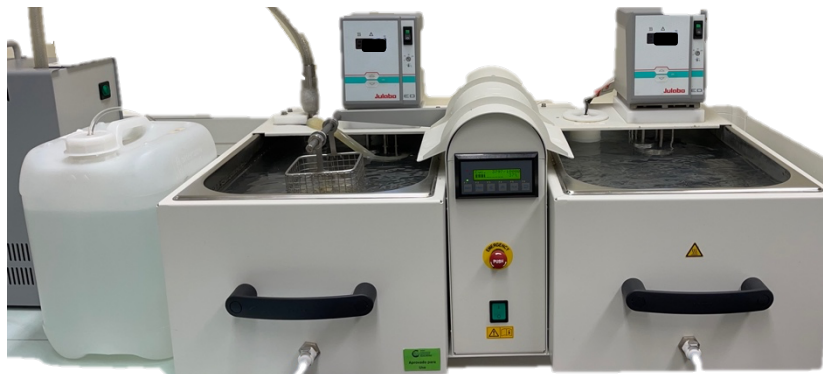
Figura 8 - Termociclador THE1100/1200 (SD Mechatronik GmbH, Feldkirchen-Westerham, Alemanha)
