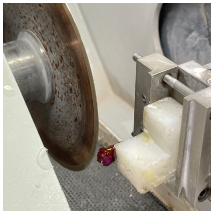
Figura 10 - Processo de secção da amostra
