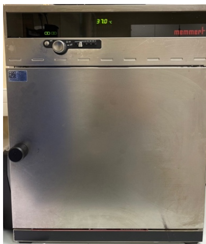
Figura 7 - Estufa Memmert INE 400 (Mettler, Alemanha)
