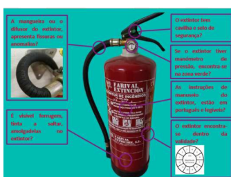
Figura 90: Pontos a verificar no extintor
