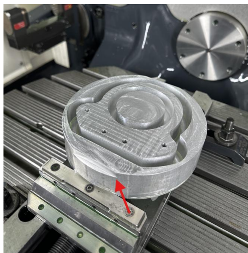
Figura 7.5 - Rasgos (assinalados pela seta) efetuados no material com geometria cilíndrica.
