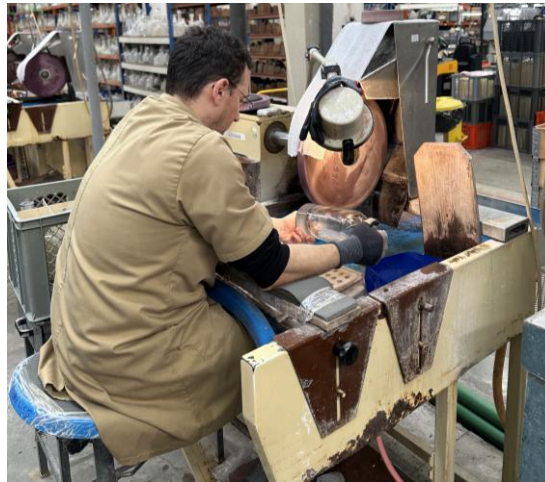
Figura 3.1 - Processo de lixagem manual de garrafas de cristal e vidro.
