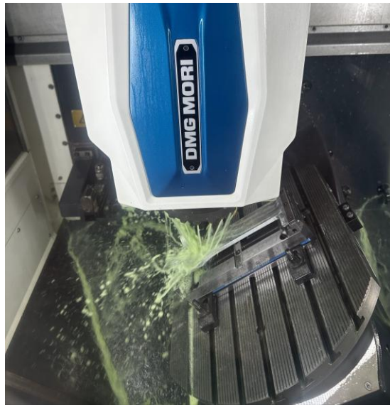
Figura 7.3 - Maquinação do corpo superior pelo quinto eixo da fresadora CNC.
