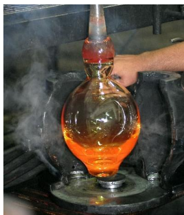
Figura 1.1 - Processo manual de fabricação de uma peça em cristal.
