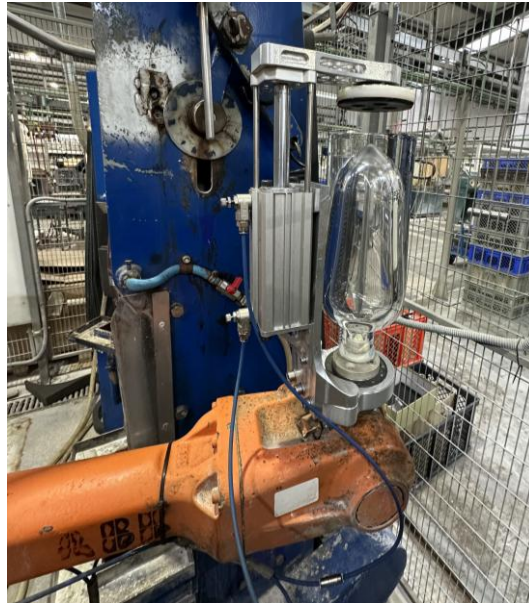
Figura 9.5 - Garra robótica manuseando uma garrafa.
