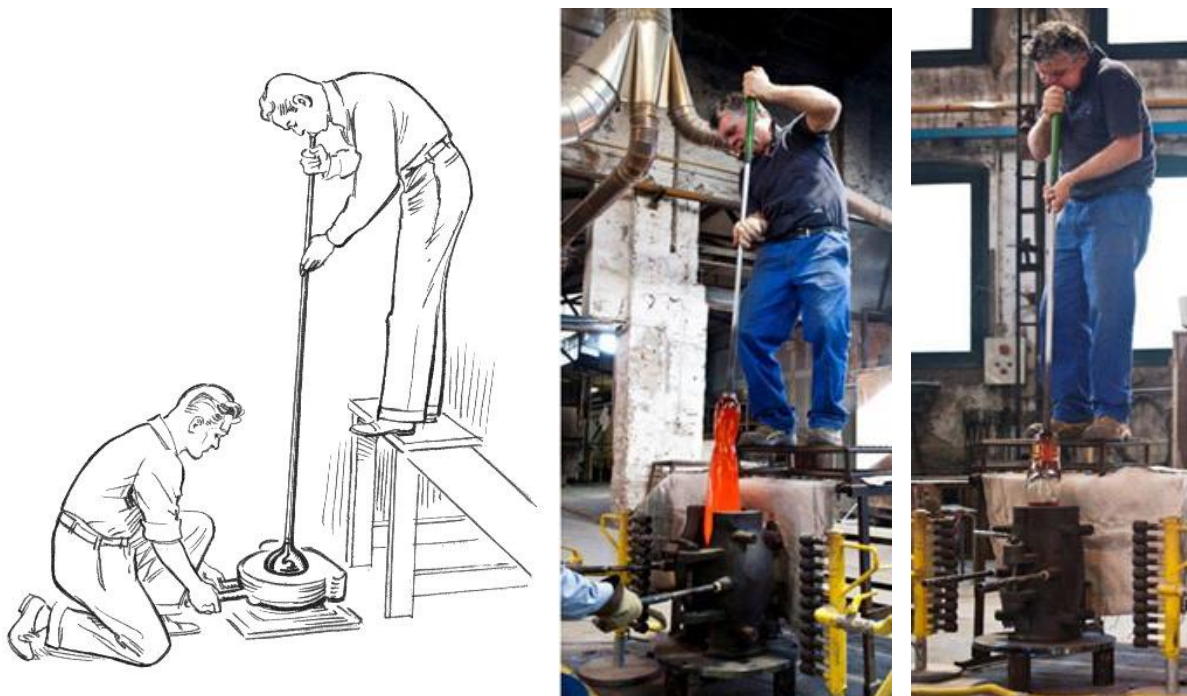
Figura 1 - Processo de fabrico do vidro através de moldação por sopro [Adaptado de (Cristais, 2016) e (PEGN, 2015)].
