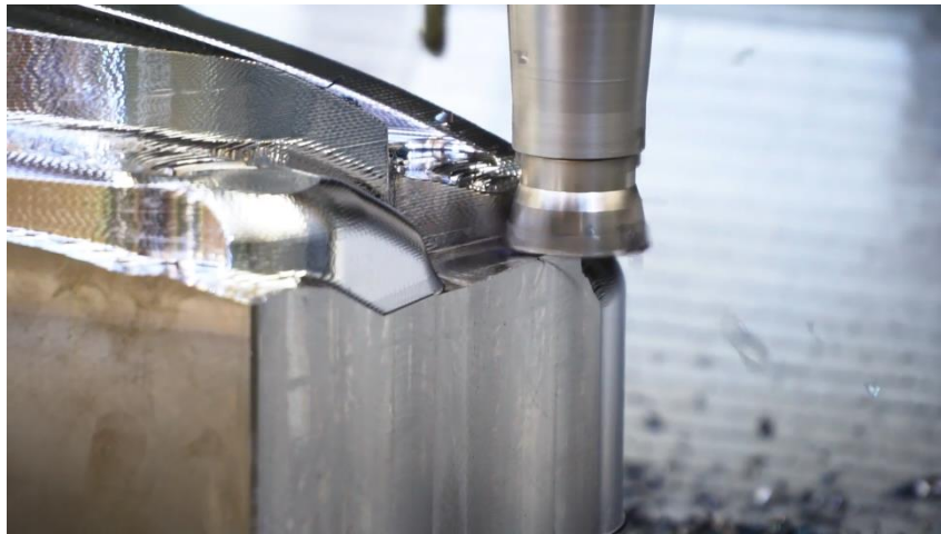
Figura 14 - Operação de desbaste [Fonte: (MoldIT, 2019)].
