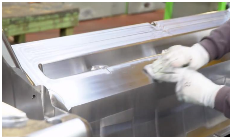
Figura 31 - Operação de polimento [Fonte: (Moldit)].
