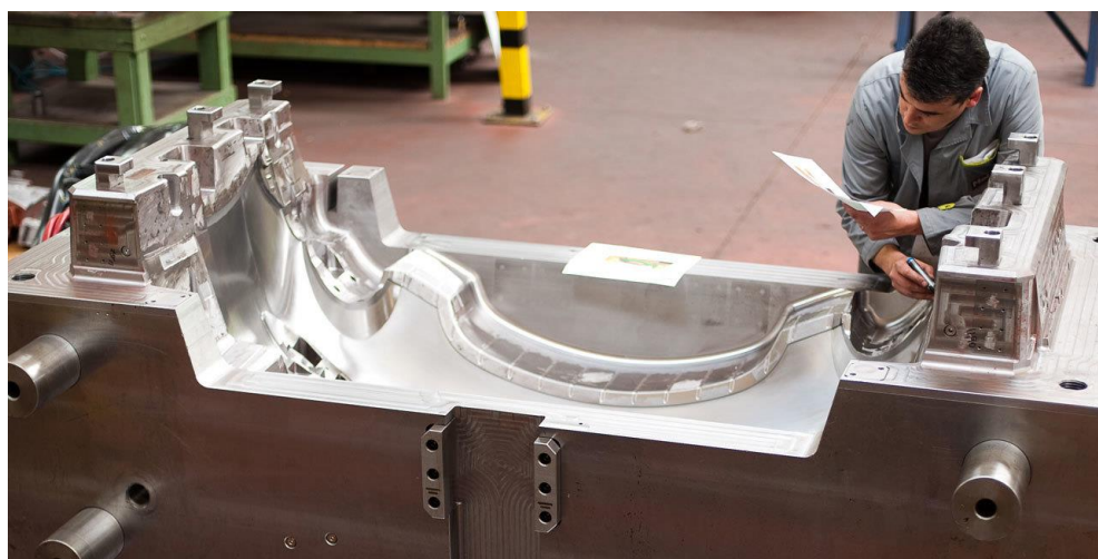
Figura 30 - Afinações e ajustes de correção no molde [Fonte: (MoldIT, 2019)].
