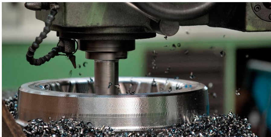
Figura 27 - Exemplo de operação de fresagem convencional [Fonte: (MoldIT, 2019)].
