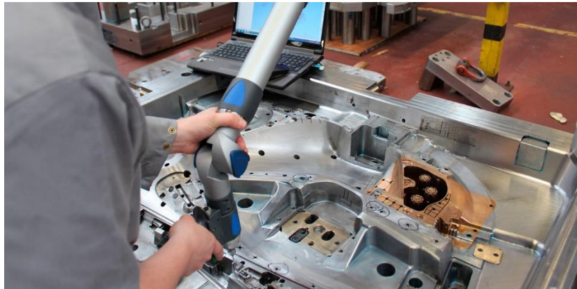
Figura 32 - Procedimento de controlo de qualidade: controlo dimensional [Fonte: (MoldIT, 2019)].
