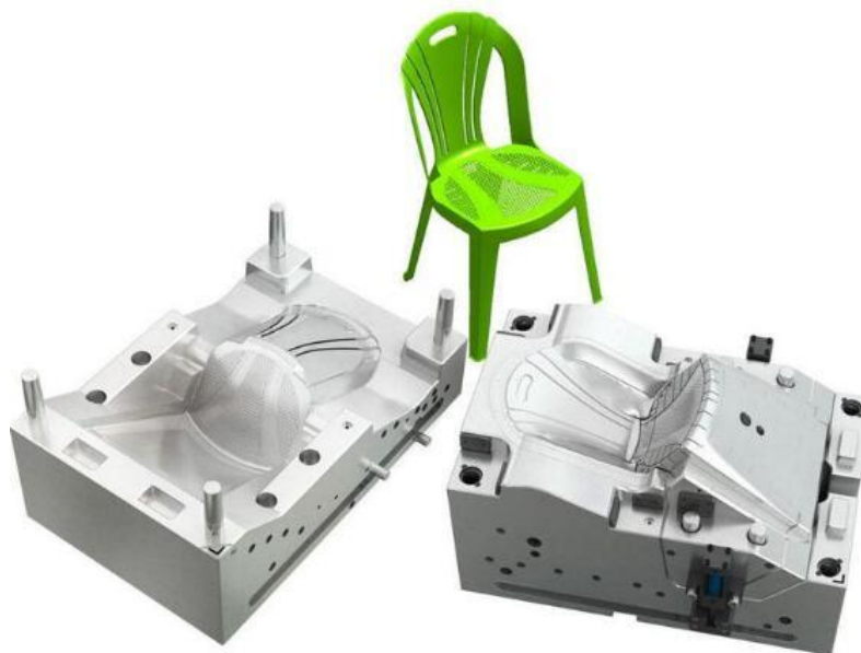
Figura 9 - Exemplo de molde para o fabrico de uma cadeira de plástico [Fonte: (Tooling&Molding)].
