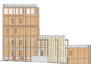
ALZADO OESTE - Con Protección Madera
