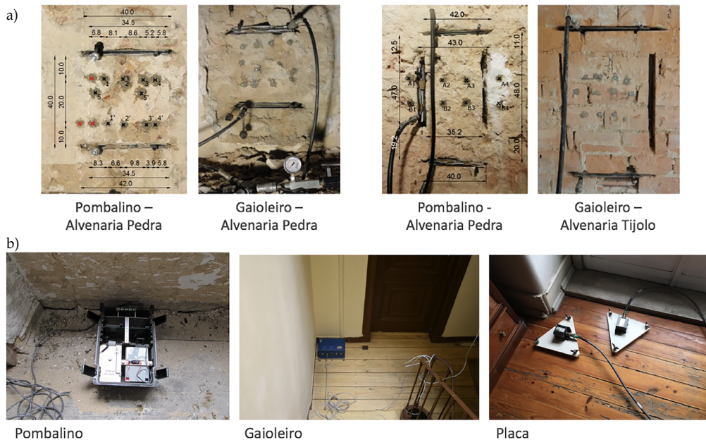
Figura 3. Exemplos de testes em PCC residencial, Lisboa: (a) Testes de macacos planos; (b) Testes de vibração ambiental para a identificação dinâmica de estruturas (Projeto Nacional FCT SEVERES, 2010-2014).
