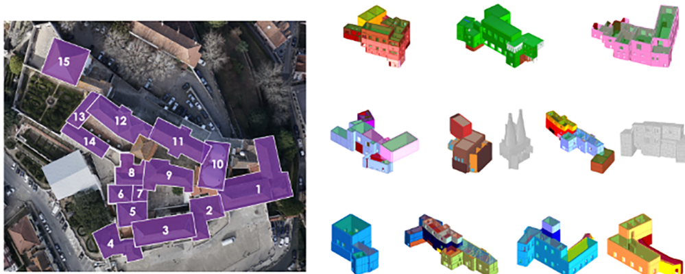
Figura 10. Modelos Numéricos Separados para os diferentes corpos do Palácio Nacional de Sintra, que representam as interações entre edifícios adjacentes.
