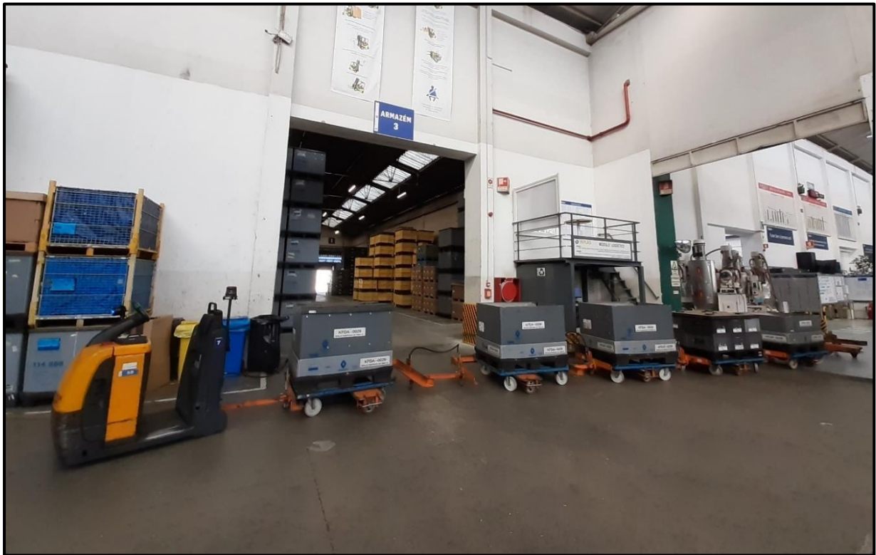
Figura 19 – Transporte de materiais por comboio
