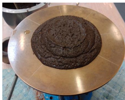
b) Argamassa espalhada.
