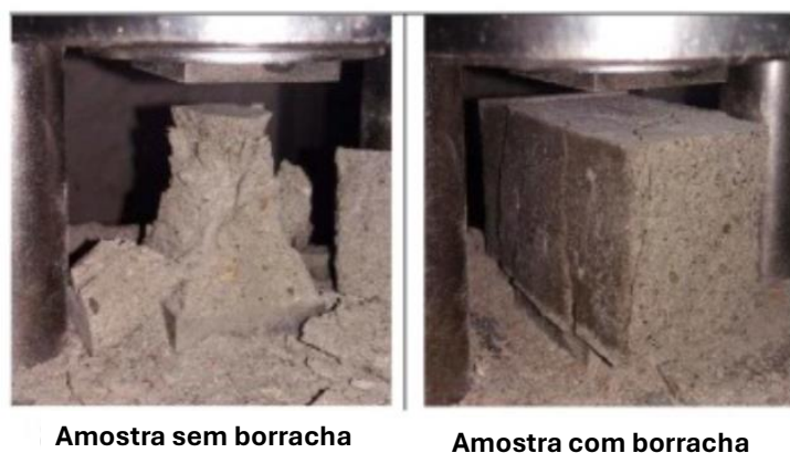
Figura 8 - Modo de rotura da argamassa geopolimérica aos 28 dias, adaptado de Abd-Elaty et al. (2022).
