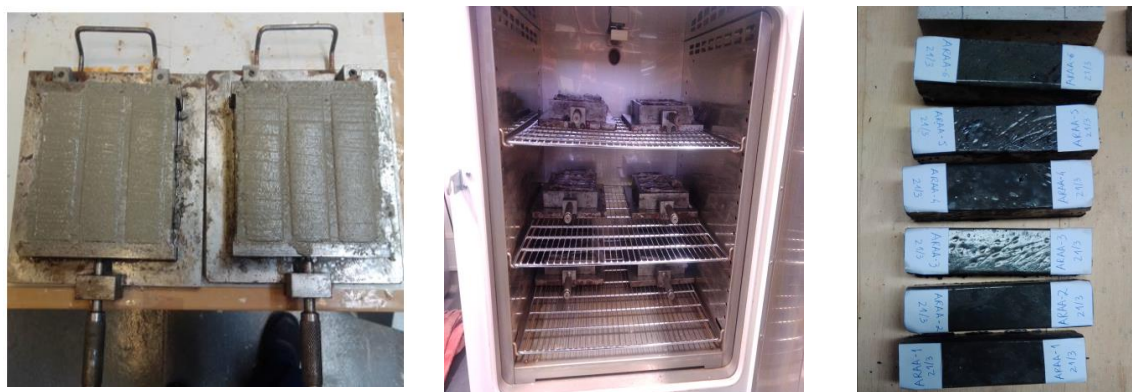
a) Cura ao ar ambiente. b) Cura em estufa a 70° C. c) Proveteos identificados.
