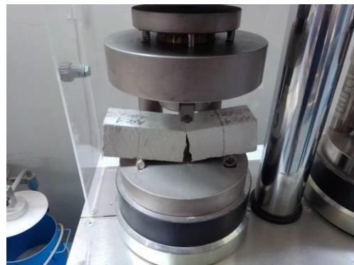
b) Rotura frágil do provete por flexão.
