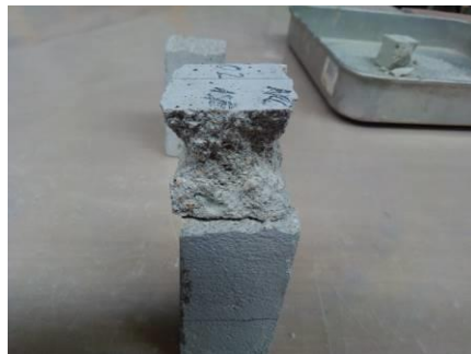
b) Modo de rotura à compressão.
