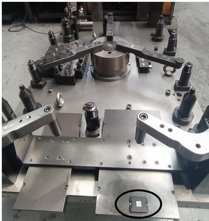
Figura 22: Aplicação física da tag RFID no JIG 524A
