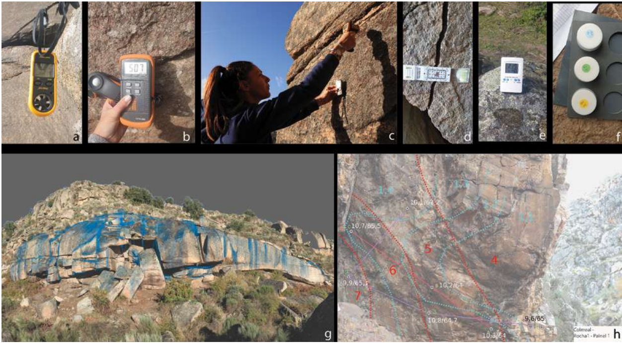
Figura 5 – Medição e monitorização dos agentes de degradação: a) medição da velocidade do vento com anemómetro; b) medição da intensidade da luz com luxímetro; c) medição de temperatura e humidade da superfície pétreia com termómetro (laser) e medidor de contacto; d) medição de movimento de fissuras com fissurómetro; e) medição da variação de T^a e H_r com termohigrómetro; f) medição de contaminantes de ar com dosímetros; g) exemplo de um mapeamento das águas de escorrências no afloramento (Lapas Cabreiras); h) exemplo de um mapeamento com as medições de T^a e H da superfície do painel (rocha 1 do Colmeal).
