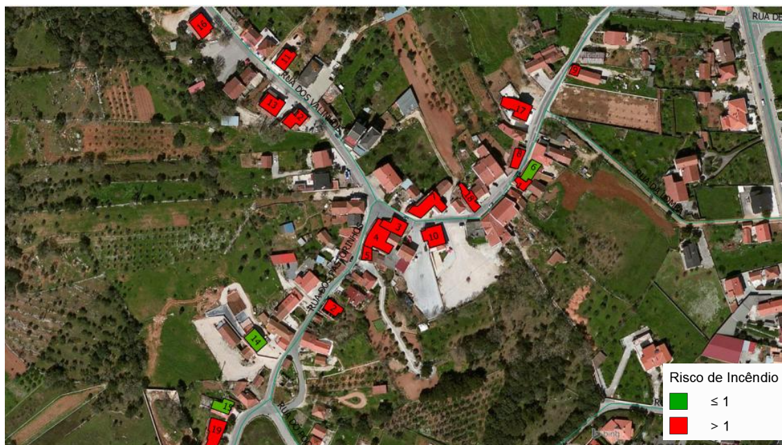
Figura 93 – Mapeamento do risco de incêndio referente aos 19 edifícios estudados [Bing Aerial with labels-QGIS 2.2]
