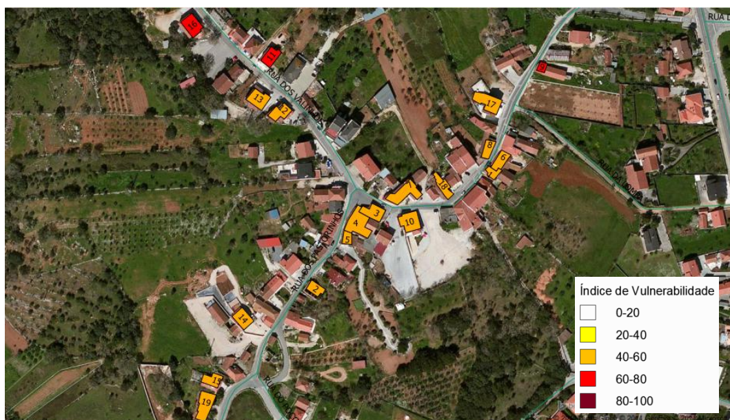
Figura 95 – Mapeamento do índice de vulnerabilidade ao risco de incêndio referente aos 19 edifícios estudados [Bing Aerial with labels-QGIS 2.2]
