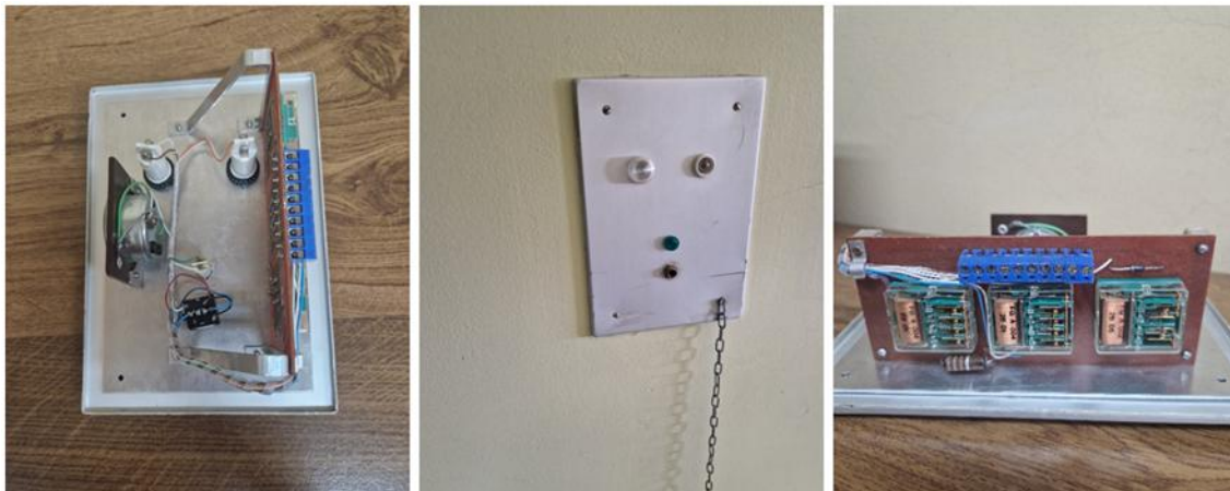
Figura 4.54 – Painel de chamada de enfermeiros escalável, com tomada fêmea tipo jack stereo .
