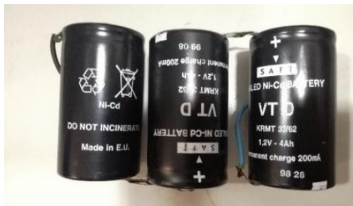
Figura 4.43 – Baterias 3x1.2V/4Ah e níquel-cádmio (Ni-Cd).
