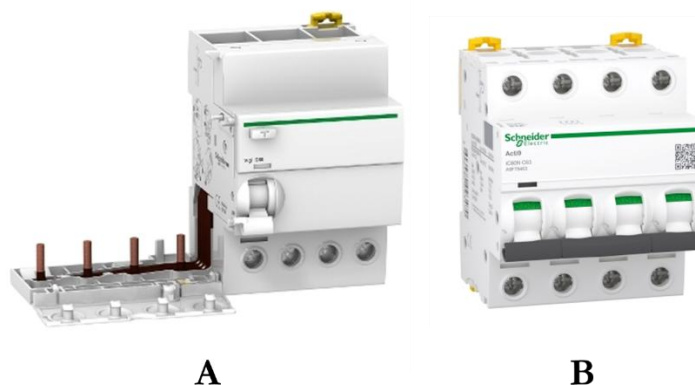
Figura 4.13 – A: Bloco diferencial Acti9 Vigi iC60, 4P, 63 A, 300 mA, de classe AC [58]; B: Disjuntor Acti9 iC60N, 4P, 63 A, de curva C, com poder de corte de 6 kA (IEC 60898- 1)/10kA (IEC 60947-2) [53], destinados à alimentação da marmita de 300 litros – Q08.
