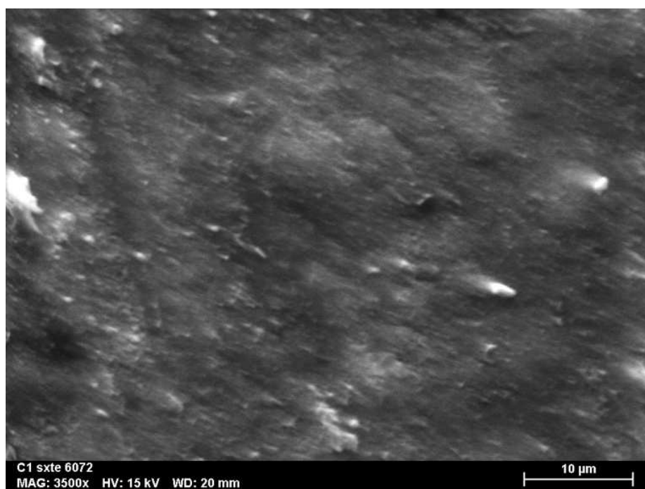
Figura 36. Imagens obtidas por Microscópio Eletrônico de Varrimento (MEV) com ampliação de 3500× da superfície da resina composta Filtek™ Supreme XTE antes da exposição ao agente branqueador à base de ácido ftalimidoperoxicaçoico (PAP)
