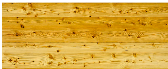
Fig. 80 – Madeira de Pinho Nórdico. Revestimento Exterior da Gruta da Reflexão
