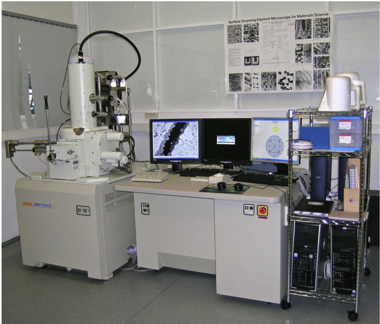
Figura 19 - Microscópio eletrónico de varrimento (MEV): FEG-SEM JEOL JSM-7001F do MicroLab no IST-UL [40].
