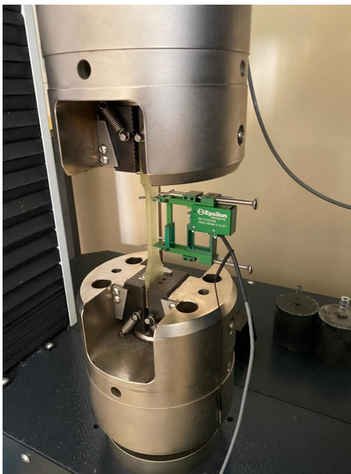
Figura 17 – Máquina de ensaios de tração TS300 e extensómetro axial Epsilon Model 3542 .
