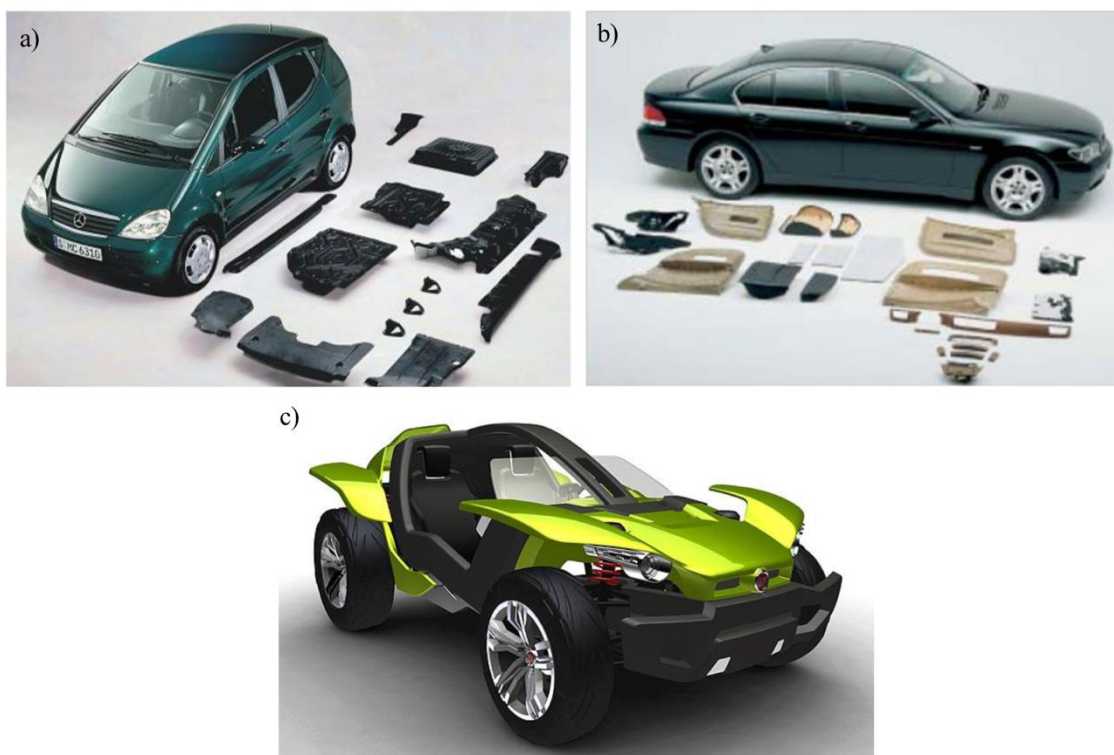
Figura 11 - Componentes automóveis produzidos com compósitos de fibras naturais: a) Mercedes Classe A; b) BMW Série 7; c) Bugster (Fiat) [30].
