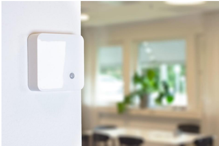
Figura 24: Nó sensor ERS2 CO2 da Elsys [96].
