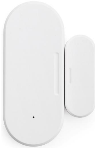
Figura 26: Nó sensor LDS02 da Dragino [98].
