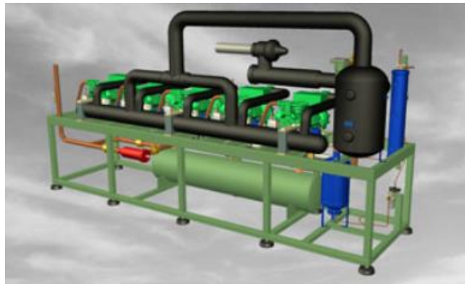
Figura 22 - Central tipo de compressores a expansão direta de R404A. Fonte: Centauro
