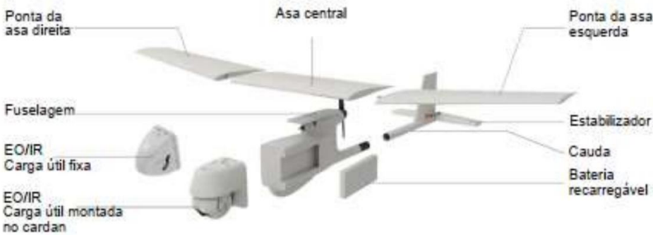
Figura 8 - Componentes do UAV RAVEN B DDL
