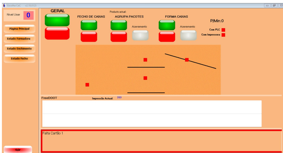
Figura 47 – Menu principal do projeto HMI do sistema semiautomático empacotamento
