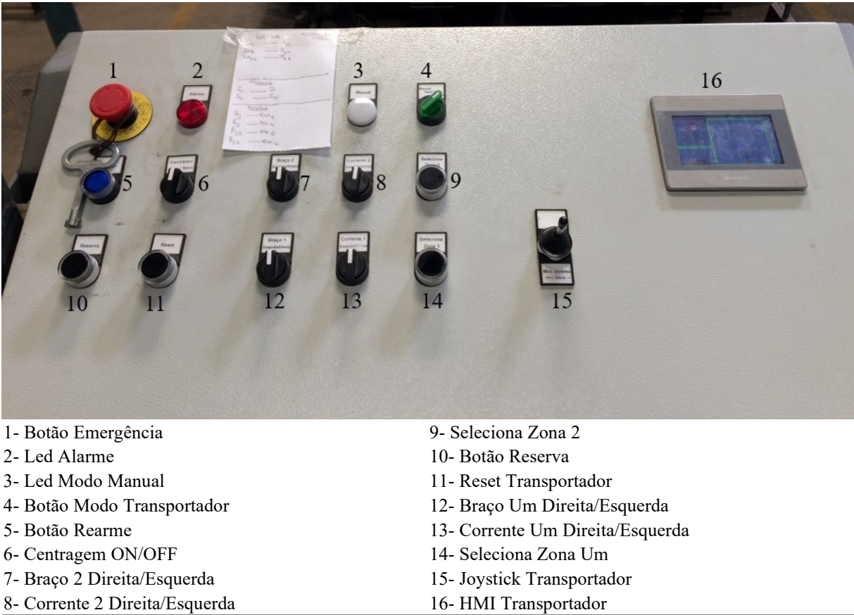
Figura 62 – Visão geral do sistema de comando do transportador de vagões
