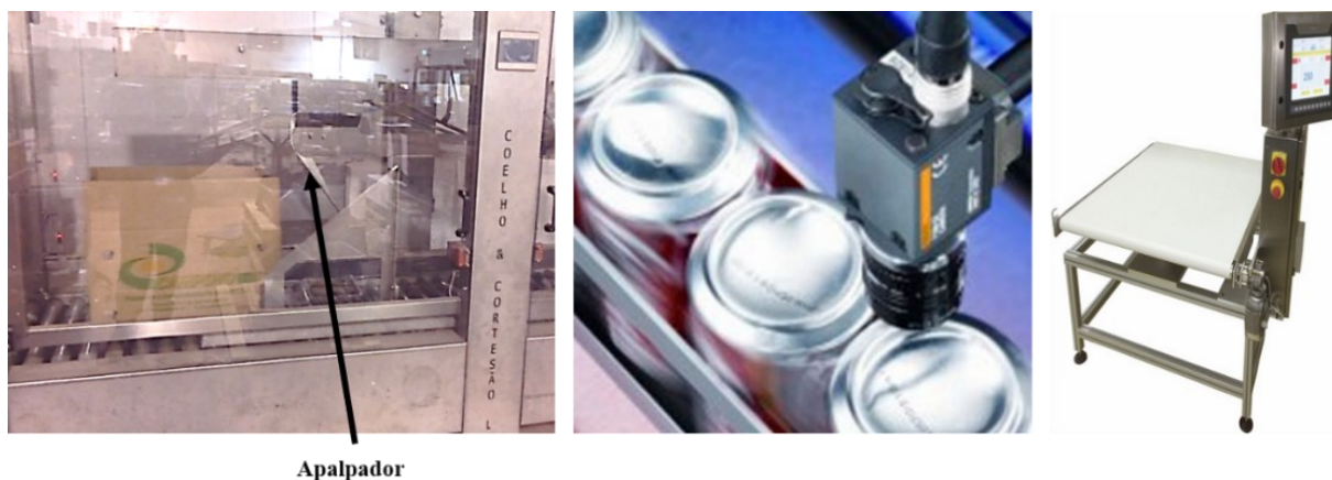
Figura 33 – Propostas de melhorias (sistema de apalpador, sistema de visão 23 e balança industrial 24 )
