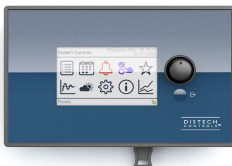
Figura 27 - Interface para controlo (D. Controls, 2021)
