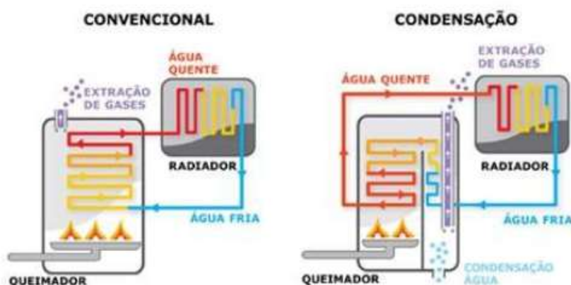
Figura 25 - Caldeira convencional vs caldeira de condensação (P. Energia, 2021)
