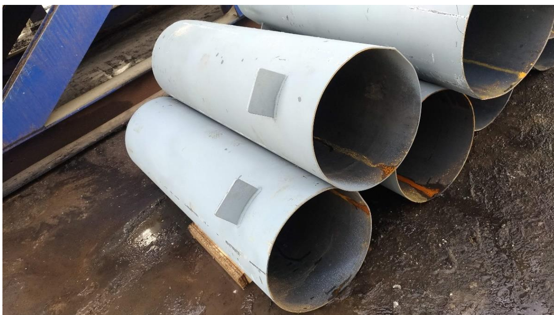
Figura 74 - Imagem do resultado final da construção de tubos em aço para proteção de pilares.
