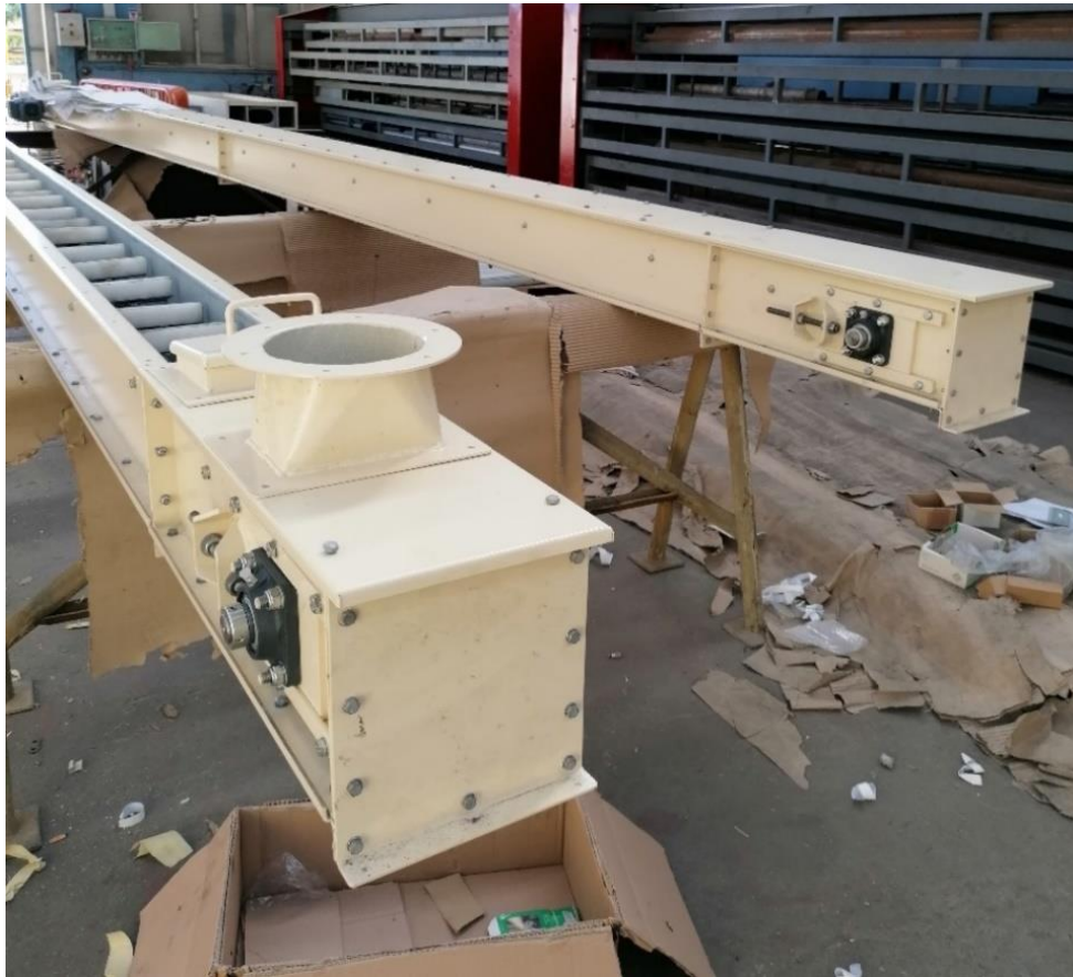
Figura 99 - Construção e montagem dos dois transportadores.
