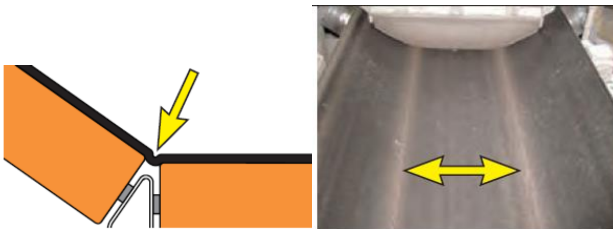
Figura 14 - Desgaste na tela proveniente de dobra entre rolos (Swinderman, et al., 2012).
