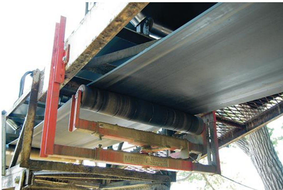
Figura 22 - Estação de alinhamento de mola de torção (Goodmaxgroup, 2021).
