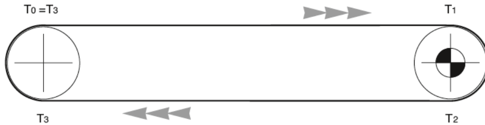
Figura 58 - Demonstração de cargas atuantes nos tambores (Rulmeca, 2019).
