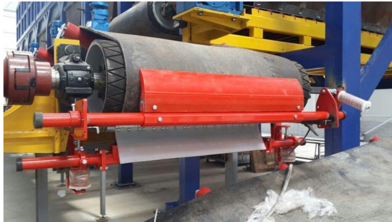
Figura 24 - Aplicação de raspador tangencial em tambor (Asgard-eng, 2021).
