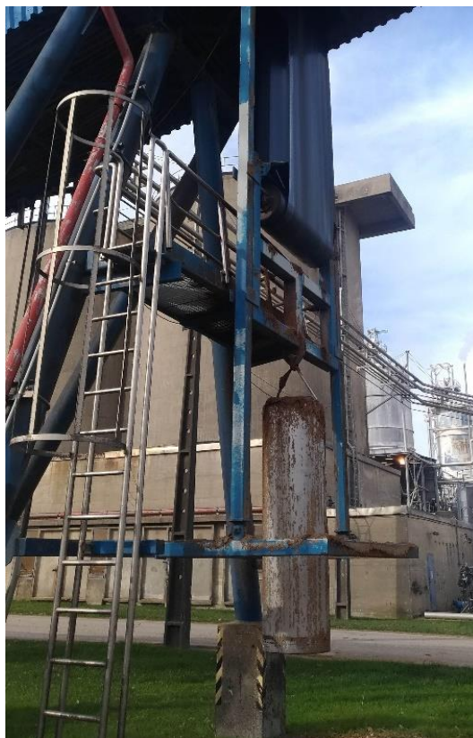
Figura 20 - Exemplo de contrapeso utilizado para esticamento de tela.
