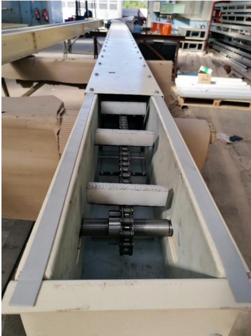
Figura 101 - Sistema de transporte através de arrastadores.
