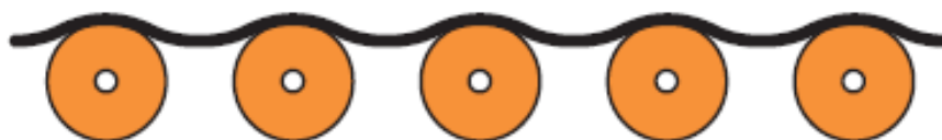
Figura 18 - Comportamento da tela no momento de queda do material (Swinderman, et al., 2012).
