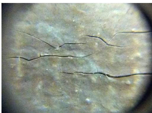
Figura 77 – Aspeto do tipo de estalado existente na camada pictórica (x 60).
