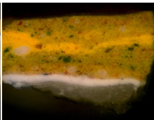
Figura 87 – Corte estratigráfico da amostra 4, referente a uma zona com mais camadas de tinta (x 220).
