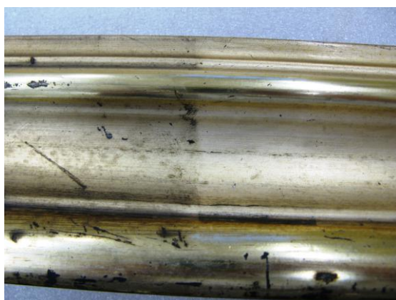
Figura 61 – Camada pictórica antes da limpeza (parte esquerda) e depois da limpeza (parte direita).
