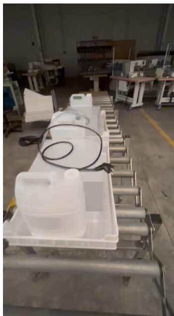
Figura 43 - Teste de Carga na Passadeira
