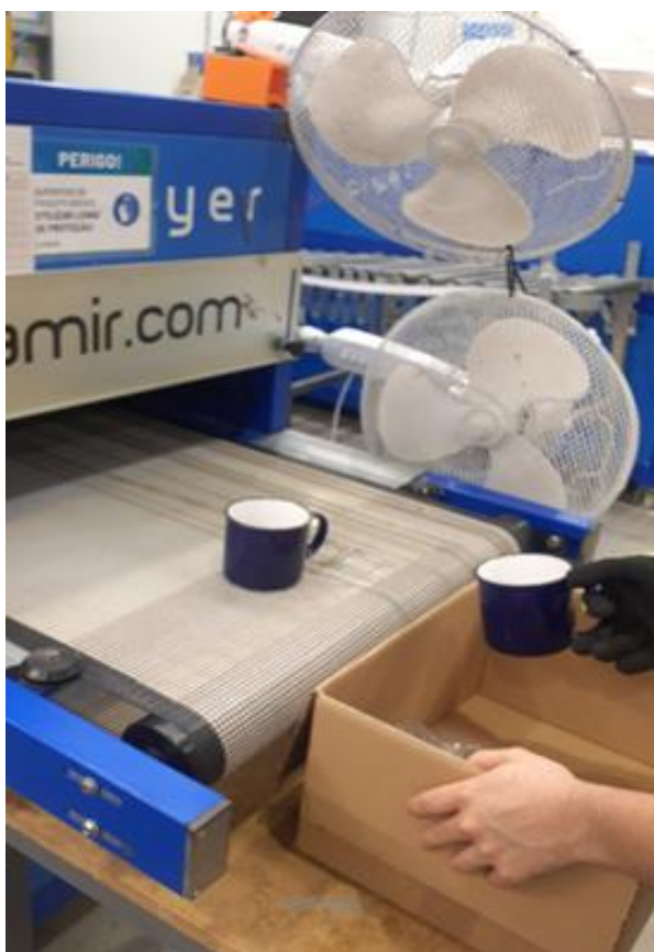
Figura 46 - Implementação das Ventoinhas
