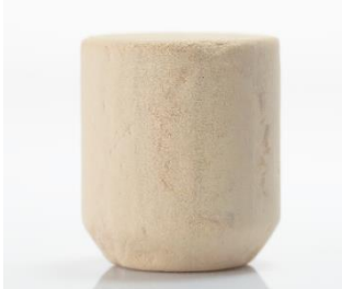
Figura 12 Rolha colmatada ( lenticelas )
