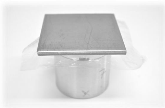
Figura 20 – Placa de metal e folha de polietileno sobre o silicone e o conjunto anel e matriz
