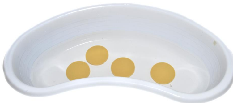
Figura 22- Imersão das amostras em Hipoclorito de Sódio a 5,25% tamponado com Ácido Bórico durante 10 minutos
