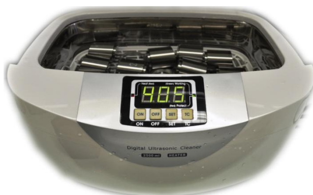
Figura 18 – Matrizes metálicas e os anéis metálicos na cuba de ultrassons.
