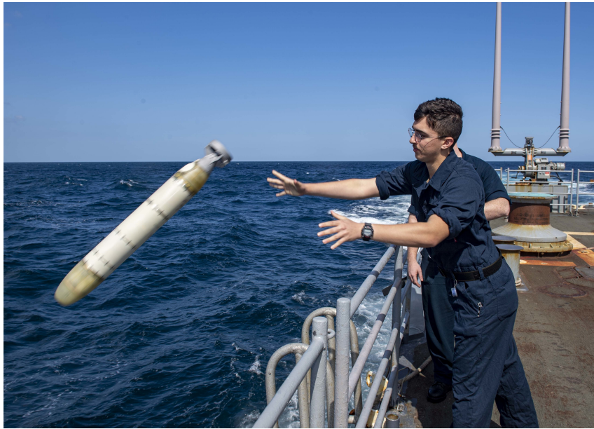
FIGURA 2.9: MK 39 EMATT a ser lançado do USS Normandy Fonte: https://twitter.com/mhmiranusa/status/1192903643902697473
