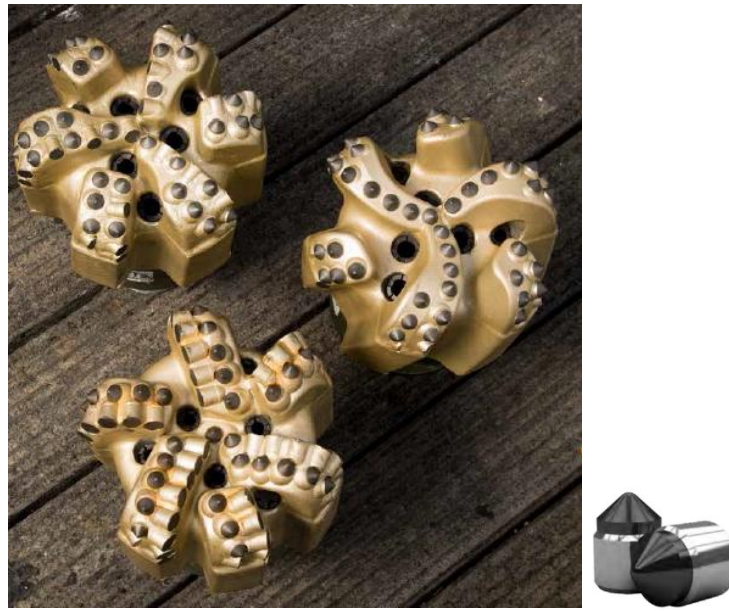
Figura 5-19: Stingblade bit, (esquerda), stinger element (direita) da figura; fonte - Schlumberger, Smith bit catalog
