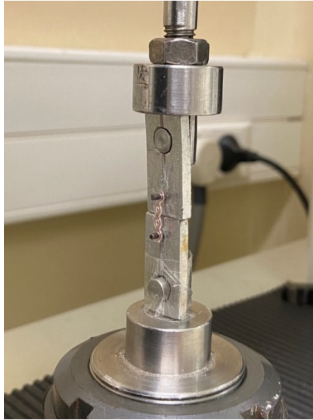
Figura 24 – Jig utilizado. O elástico foi colocado nos apoios de cada uma das peças do jig . Este foi inserido na máquina de teste universal Shimadzu Autograph AG-IS para a realização das medições.
