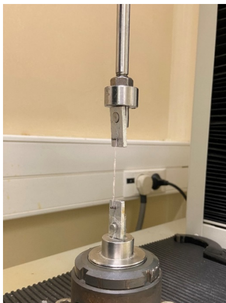
Figura 26 - Momento da tração da cadeia elástica a uma velocidade de 100 mm/min na máquina de teste universal Shimadzu Autograph AG-IS.
