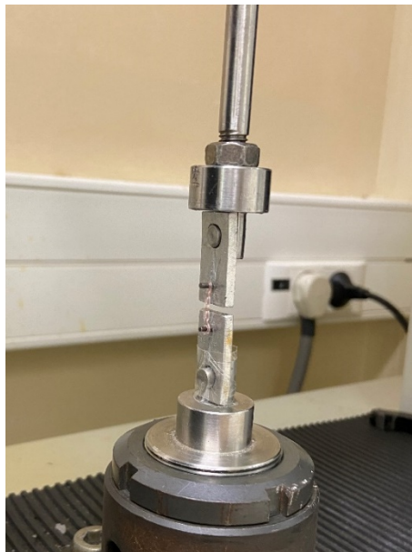
Figura 25 - Momento da medição da força exercida pelo elástico em 50% de estiramento na máquina de teste universal Shimadzu Autograph AG-IS.
