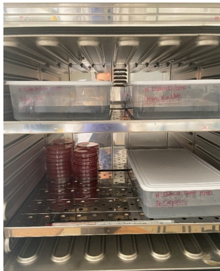
Figura 18 - Cadeias elásticas em saliva artificial na estufa a 37°C.
