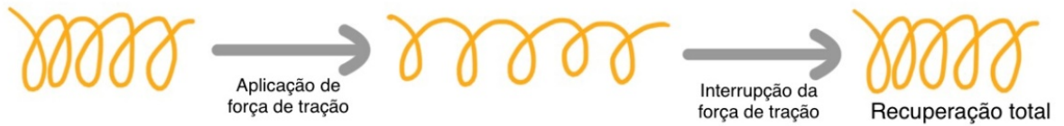
Figura 2- Representação esquemática da deformação elástica ou reversível sofrida por uma cadeia polimérica (Adaptado de Anusavice et al, 2013).
